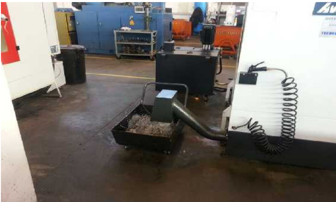
Слика 3.8. Елеватор за избацивање струготине из машине и пиштољ за прање машине
