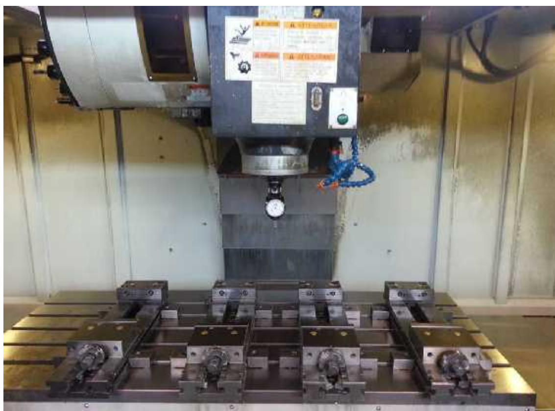
Слика 3.6. Радни сто на коме су постављене стеге и главно радно вретено у коме се тренутно налази компаратер
