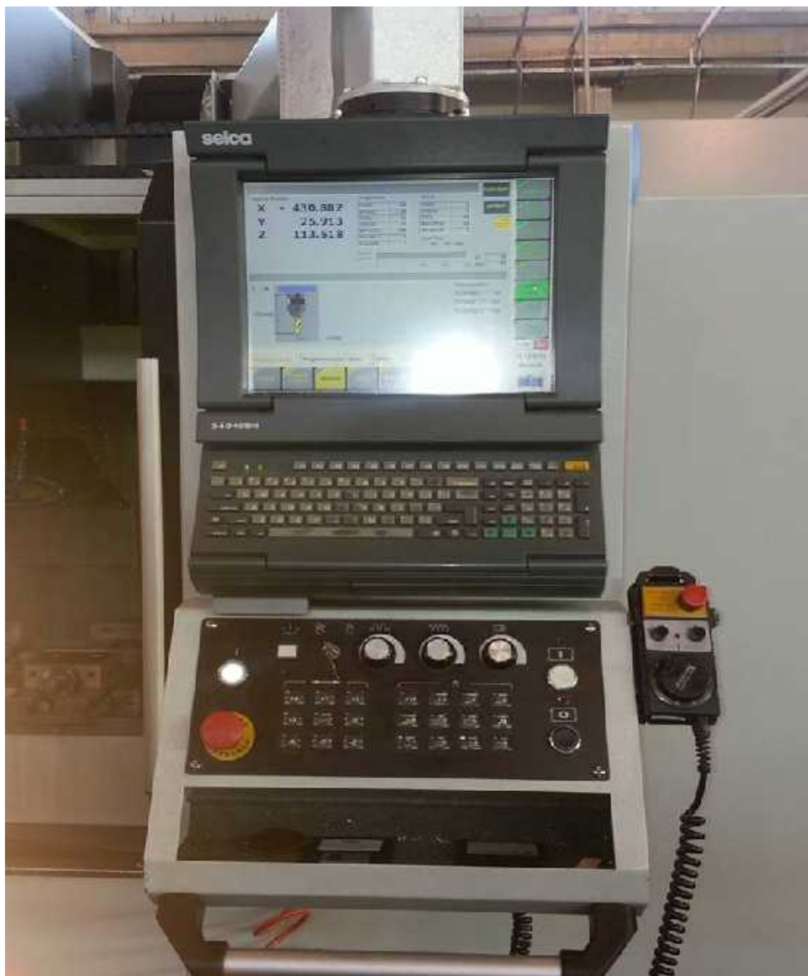
Слика 3.9. Рачунар са управљачком јединицом SELCA и командна табла
