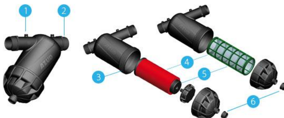
Слика 30 – Елементи филтера AZUD (1 - прикључак за мерење притиска, 2 – прикључак на систем, 3 – кућиште филтера, 4 – модуларни филтер, 5 – површина за филтрацију, 6 – помоћни прикључак ) [13]
