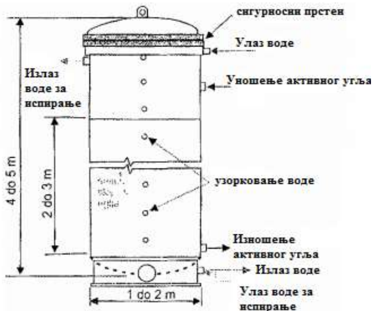
Слика 22. Адсорпциона колона
