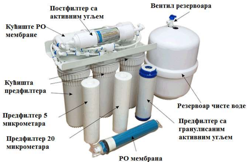
Слика 28. Систем реверзне осмозе
