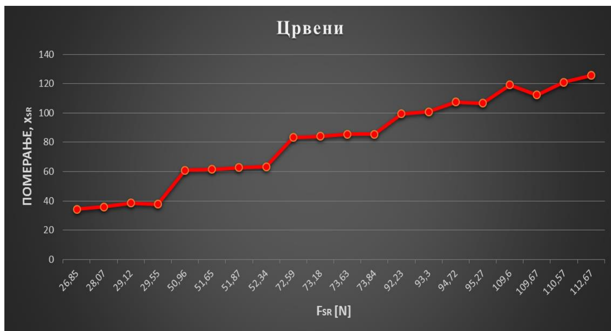
Слика 4.1 Дијаграм са вредностима тангенцијалне динамичке силе и померања првог испитаног узорка стезног алата
