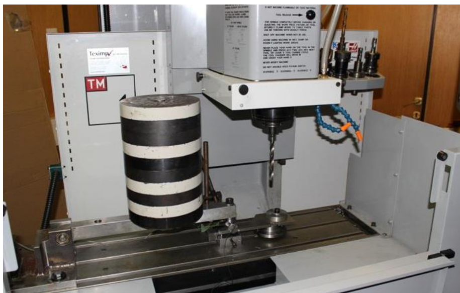
Слика 3.6 Уређај за моделска испитивања динамичке попустљивости контакта између елемената за стезање и радног предмета
