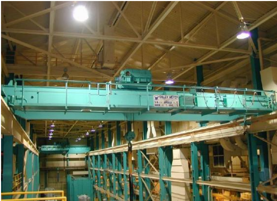
Слика 6: Двогреда мосна дизалица - кутијаста носач, [12].
