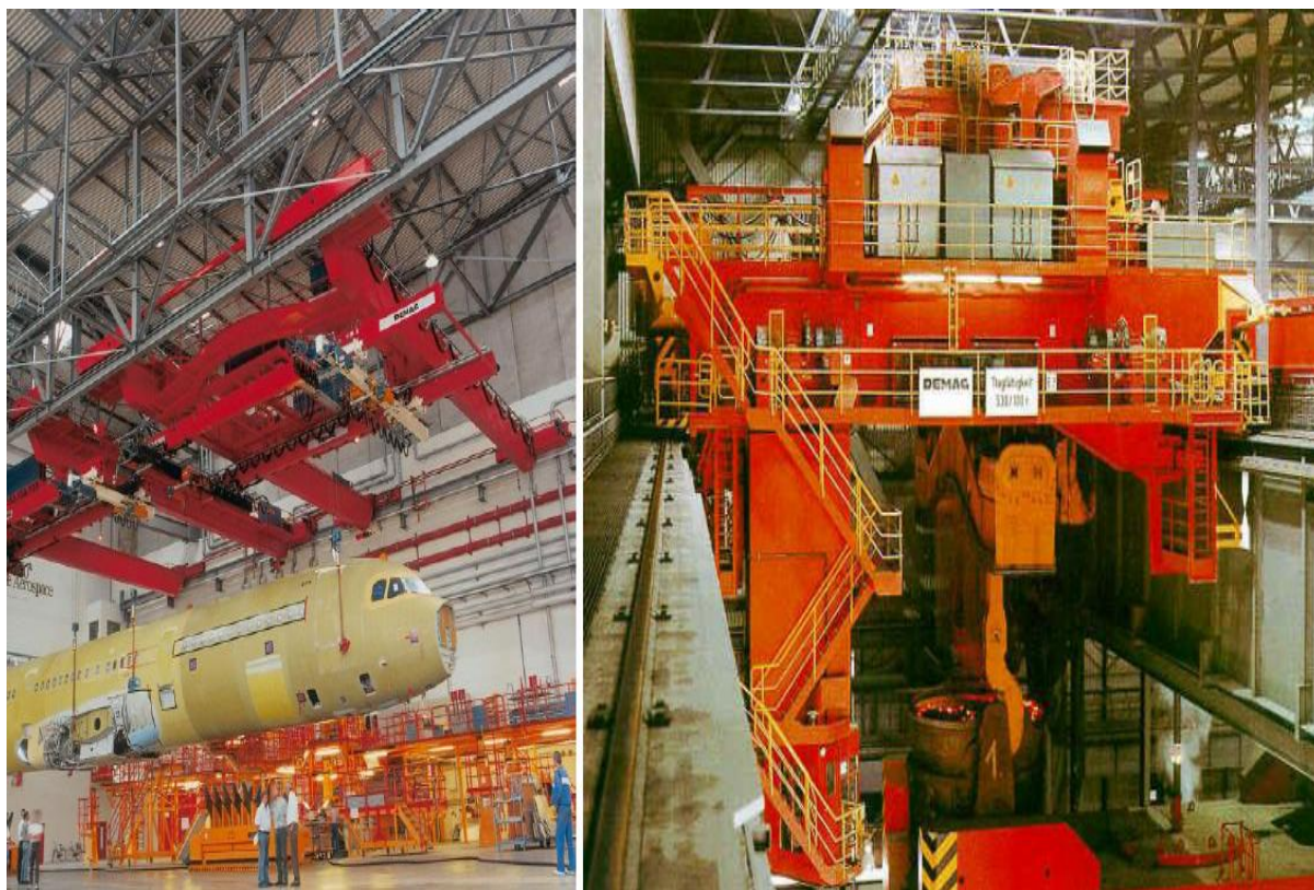
Слика 10: Специјалне конструкције мосних дизалица, монтажа авиона (лево) и рад у ливници (десно), [12].
