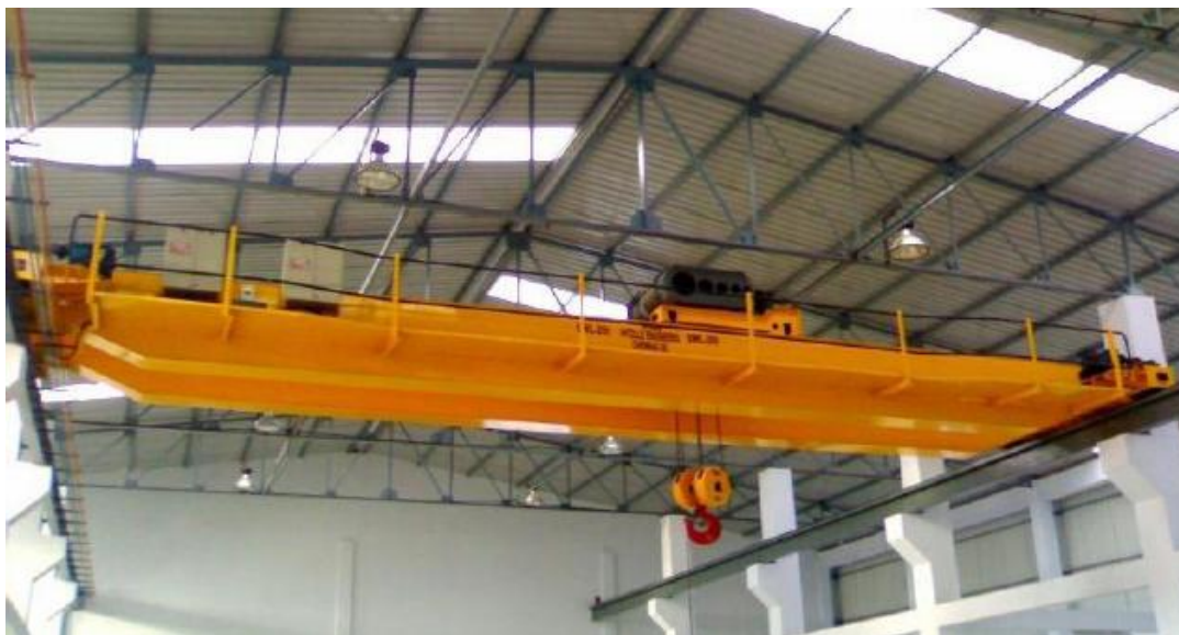
Слика 4: Положај мосне дизалице у хали испод кровног носача, [12].
