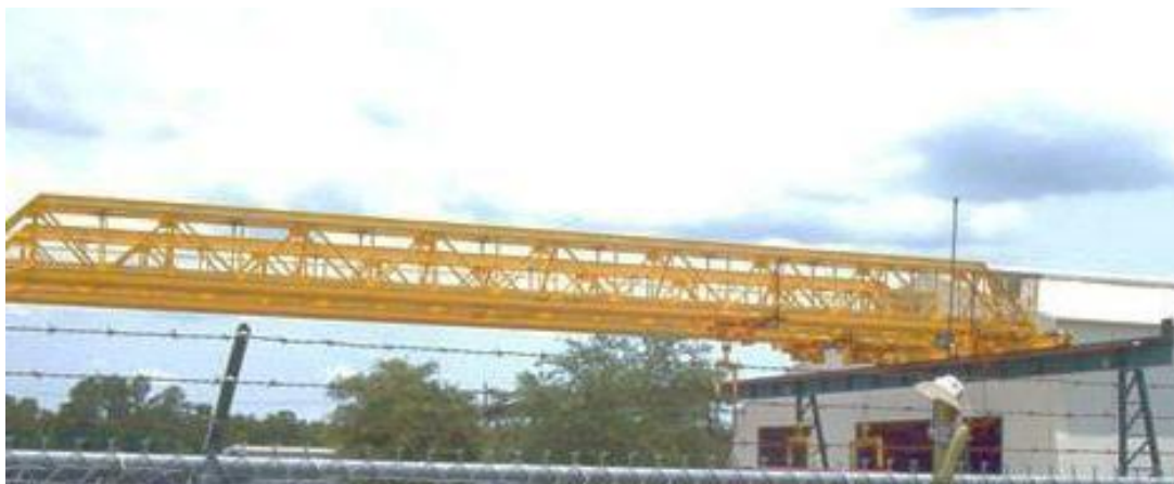
Слика 5: Двогреда мосна дизалица - решеткаста конструкција, [12].
