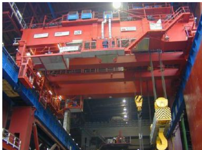
Слика 8: Четворогреда ливачка дизалица са двоје колица (једна пролазе испод других), [12].
