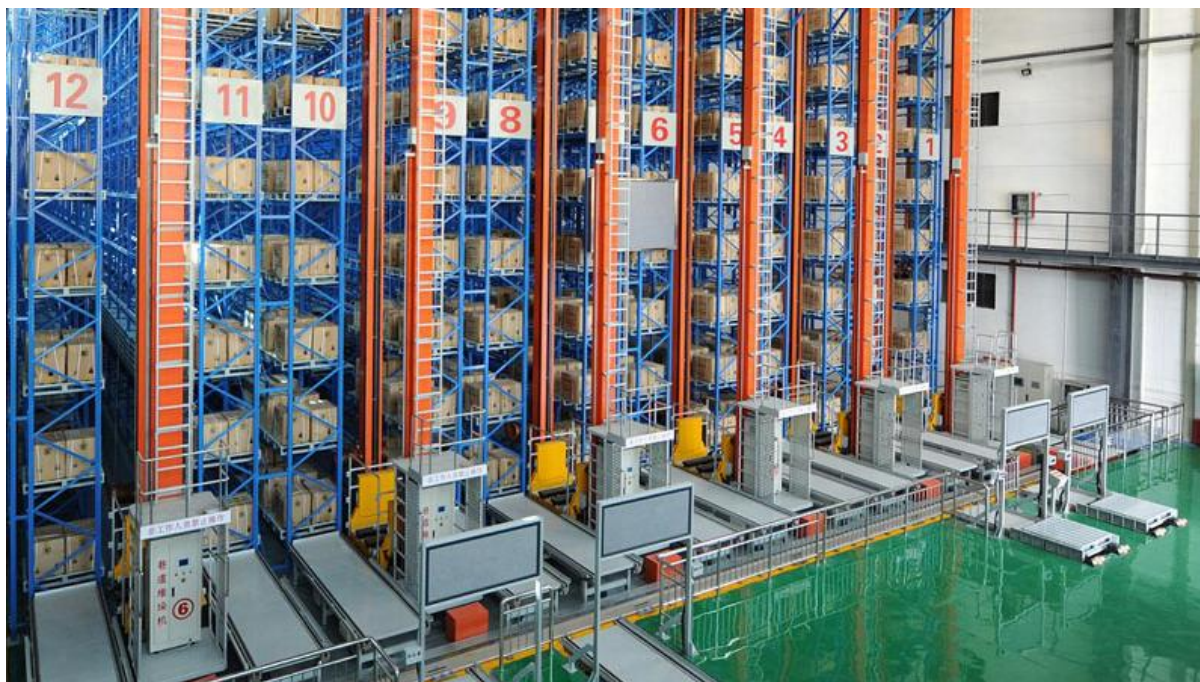
Слика 11: Аутоматизовано управљање дизалицама у регалним складиштима, [13].
