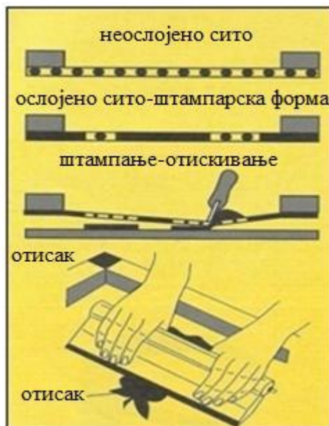
Слика 59. - Добијање отиска у ситошtamпи [3]
