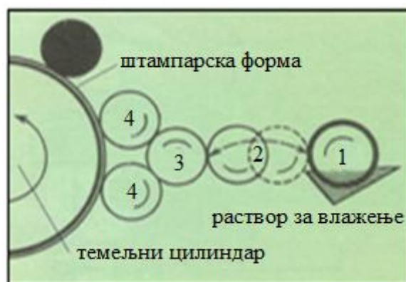
Слика 45. - Шематски приказ уређаја за влажење: 1) ваљак доносач (дуктор), 2) ваљак раздљивач, 3) ваљак разрибач и 4) ваљци брисачи - наносачи [3]
