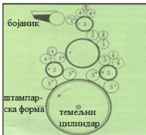
Слика 46. - Шематски приказ уређаја за обојавање: 1) ваљак раздљивач, 2) ваљак разрибач, 3) ваљак везивач, 4) ваљак преносач и 5) ваљак наваљивач [3]
