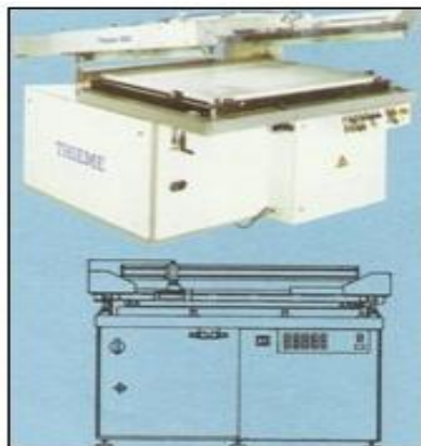
Слика 61. - Полуаутоматске машине са ситоштампу [3]
