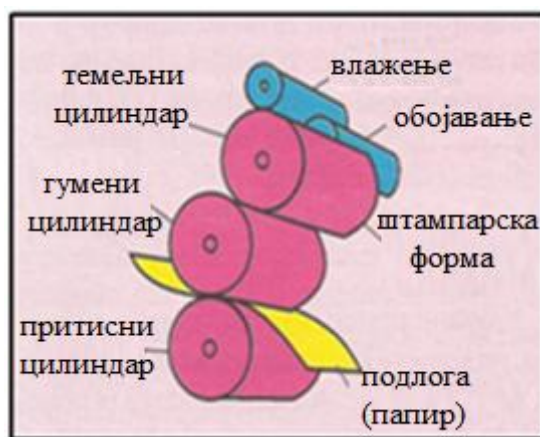
Слика 40. - Приказ индиректног принципа преноса боје са штампарске форме на подлогу код офсетне штампе [3]
