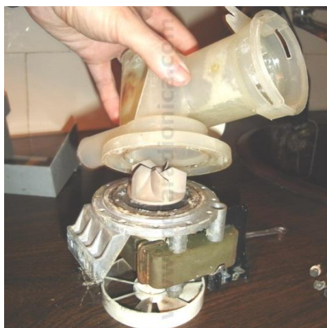
Слика 35: Запушење електромоторне пумпе
