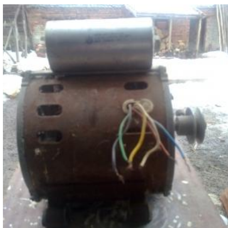
Слика 6: Електромотор са шест прикључних извода
