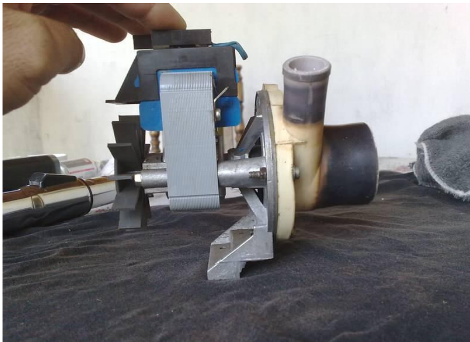
Слика 8: Електромоторна пумпа
