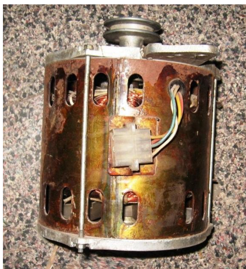
Слика 34: Прегорели погонски електромотор
