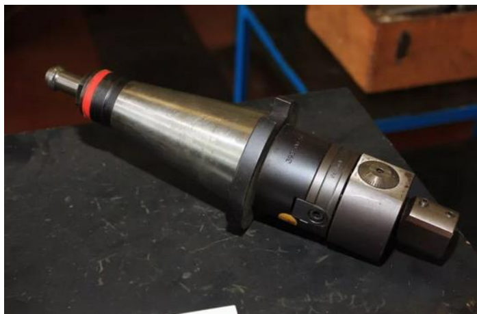
Слика 25. Брзоизмењива проклизавајућа глава бушилице [13]
