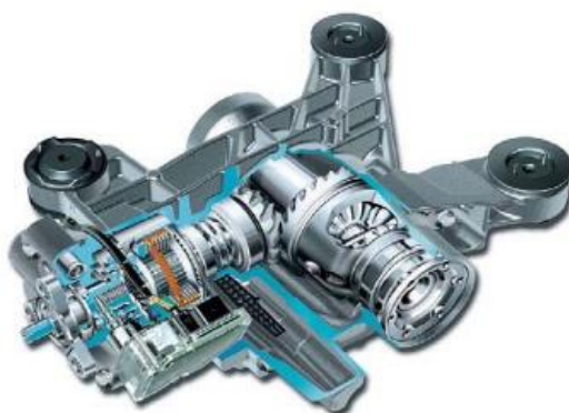
Слика 43. Виско-спојница на задњој осовини диференцијала возила Golf 4 MOTION [19]
