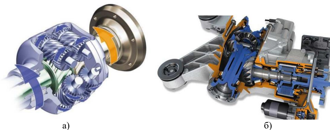
Слика 24. Конструкције диференцијала (а- Торзен диференцијал и б- самокочни диференцијал) [10]
