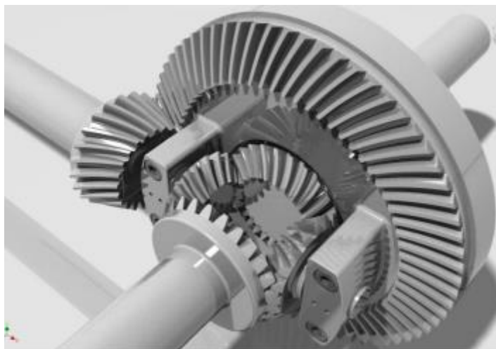
Слика 17. Делимични пресек главног преносника и диференцијала са коничним зупчаницима [15]
