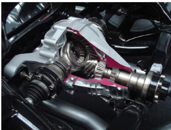
Слика 2. Приказ аутомобилске јединице са диференцијалом [8]
