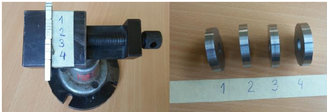
Слика 7.9 Приказ триболошког пара – узорци са траговима хабања и дискови након испитивања
