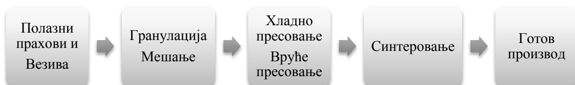
Слика 3.2 Шема производног процеса у металургији праха [2]
