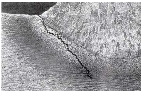
Слика 6.3 Иницијална прсина услед заосталих напона [1]
