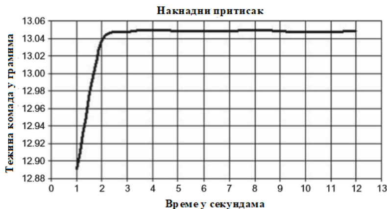
Слика 5.14 Маса убризгана у калуп у функцији од времена [1]
