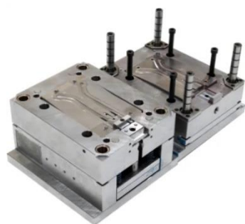
Слика 5.6 Калупи за МИМ бризгање [1]
