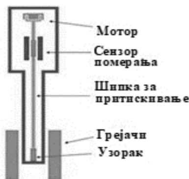
Слика 6.11 Дилатометар „SETSYS evolution“ [7]
