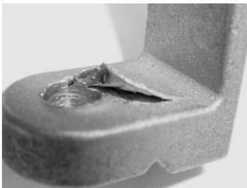
Слика 6.4 Одвајање површине дела при бушењу услед мале концентрације металних честица у том подручју [1]
