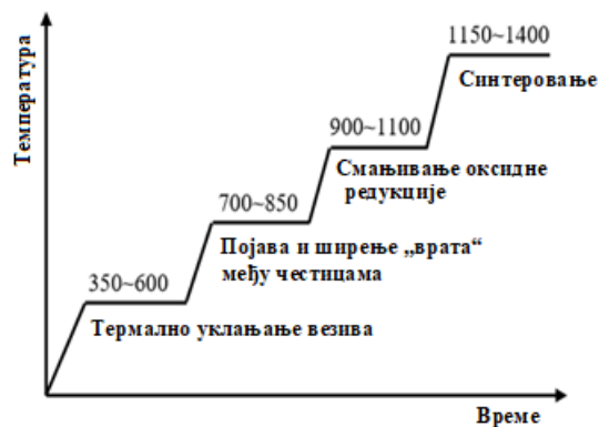
Слика 4.9 График циклуса током синтеровања и пресинтеровања у четири фазе за нерђајући челик [7]
