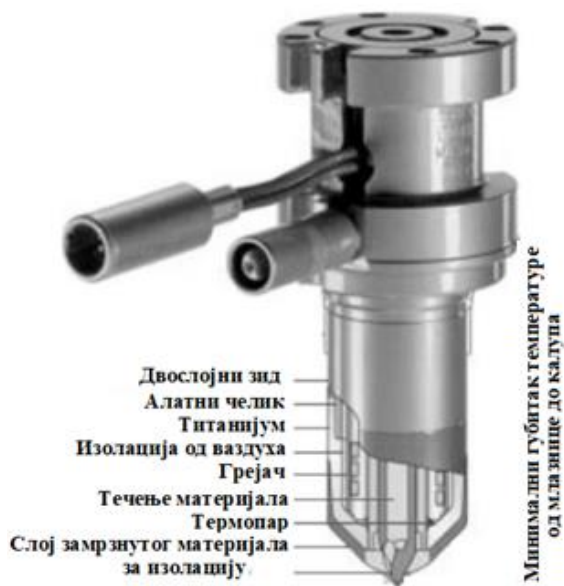
Слика 5.11 МММ бризгалка са електронским компонентама [1]
