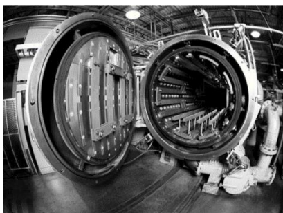
Слика 5.19 Пећ са графитним елементима [1]
