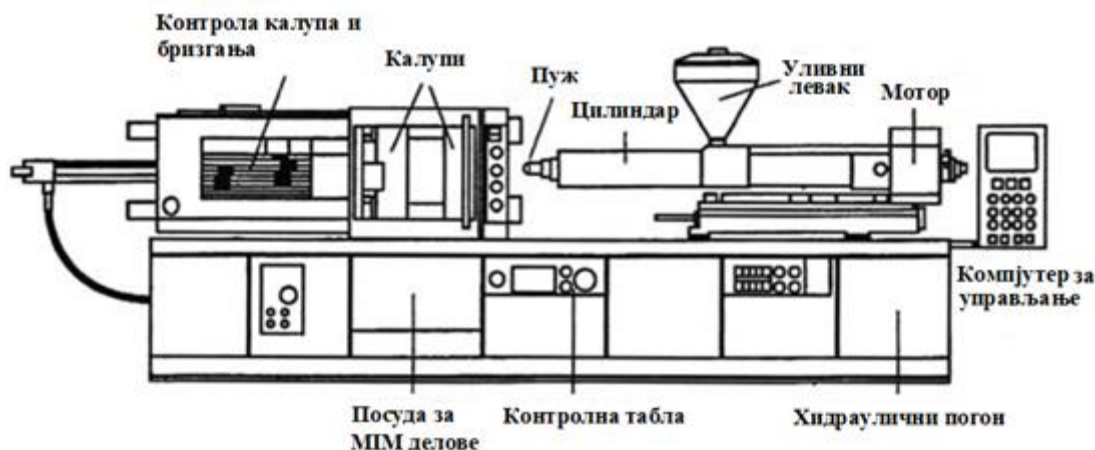
Слика 5.1 Елементи машине за инјекционо бризгање метала [6]
