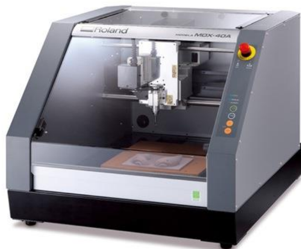
Слика 57. Глодалица марке Roland модел Modela MDX-40A, [5]
