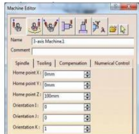
Слика 2.26 – Дефинисање машине
