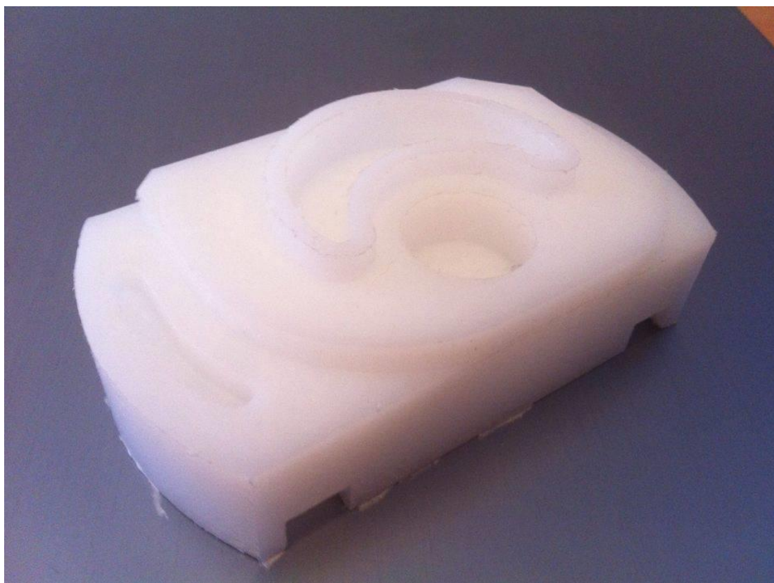
Слика 4.17 – Завршене све обраде, готов део урађен на машини
