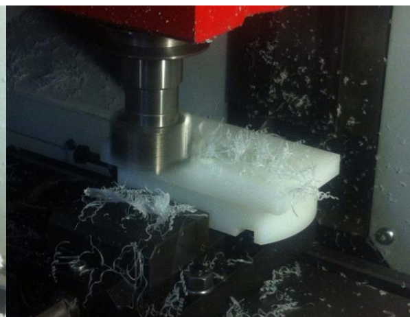
Слика 4.12 – Окретање предмета обраде и обрада друге чеоне површи
