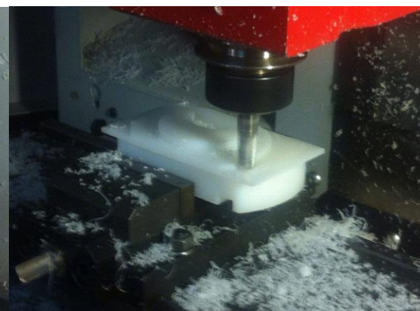
Слика 4.12 – Окретање предмета обраде и обрада друге чеоне површи
