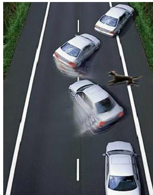
Слика 17 – Понашање возила без ABS-а
