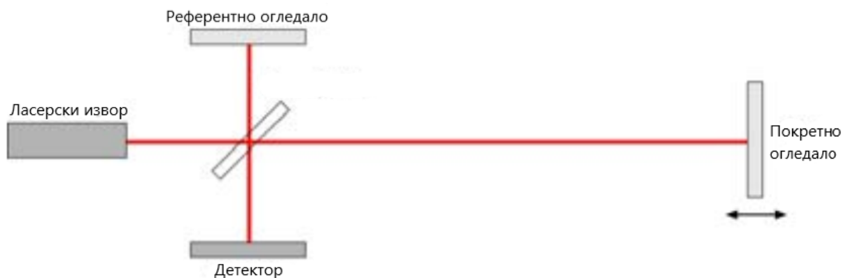
Слика 4.13. Принцип Микелсоновог интерферометра [22]
