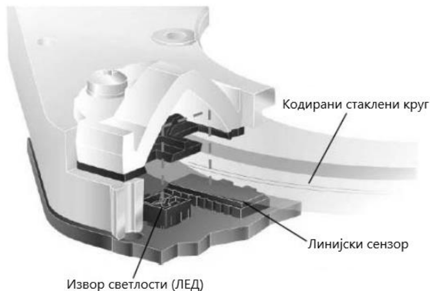
Слика 4.17. Појединачни кодер система за мерење угла са извором светлости (ЛЕД) и линијским сензором [25]
