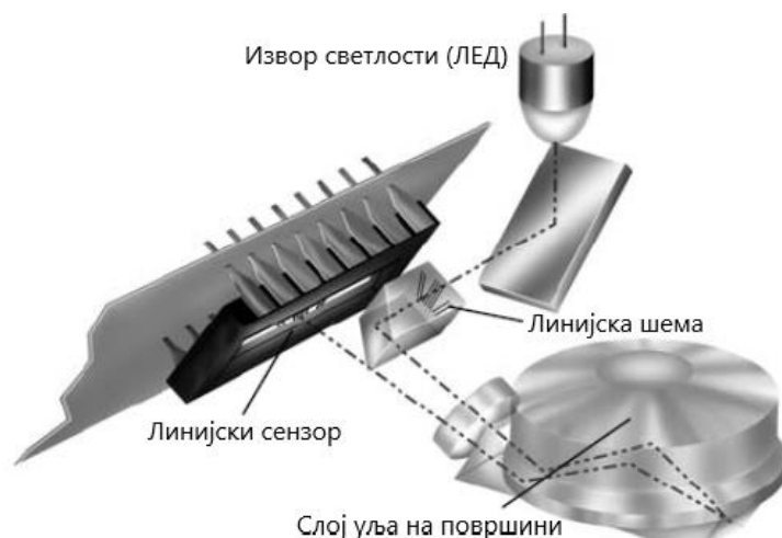
Слика 4.18. Принцип двоосног сензора нагиба [25]
