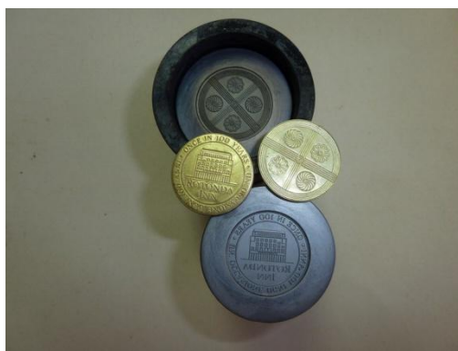
Слика 3.4 Ковање у калупу: схематски приказ (лево) и ковање новчића у калупу (десно)
