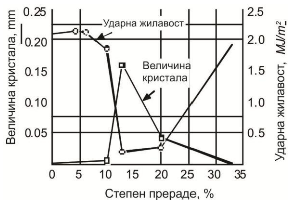
Слика 2.3 Утицај грубозрнате рекристализације на зарезну жилавост меког (нискоугљеничног) челика
