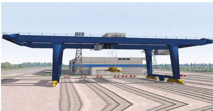
Слика 20. Сандучаста конструкција порталне дизалице [4]
