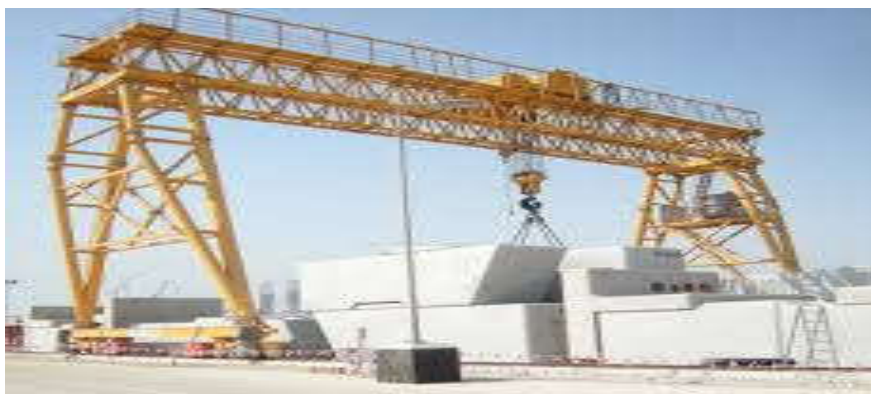
Слика 19. Решеткаста конструкција порталне дизалице [4]
