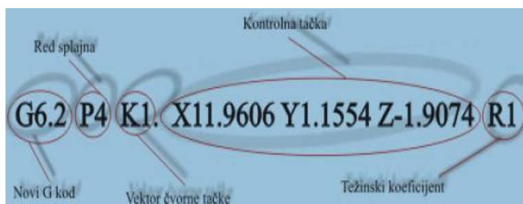
Сл. 5. Формат једног блока података NURBS интерполације који је формиран помоћу адекватног постпроцесора, за управљачку јединицу једног произвођача[4]
