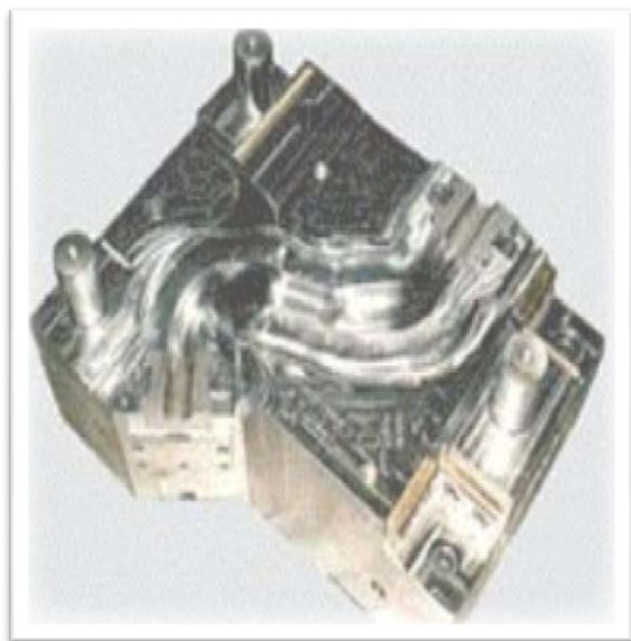
Сл. 6. Део алата који је израђен коришћењем NURBS интерполације и класичног програмирања[4]
