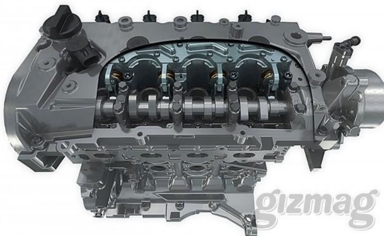
Слика67. Пресек главе мотора са актуаторима и системом MultiAir[9]
