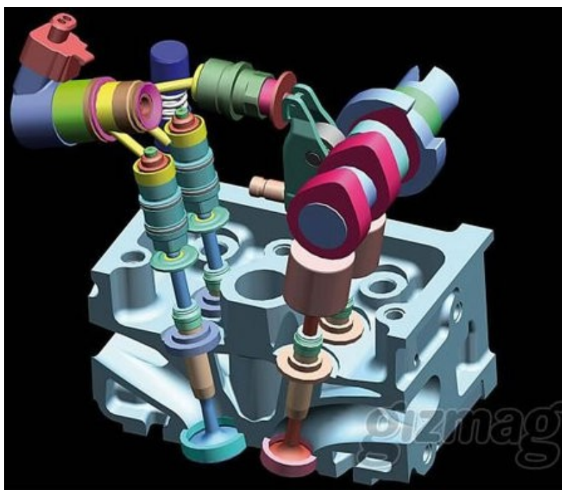
Слика 65. Пресек главе са компонентама система MultiAir[9]
