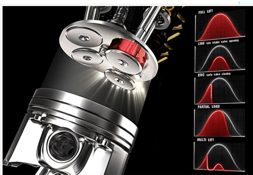
Слика 69. Дијапазон рада MultiAir система при различитим обртајима мотора[9]
