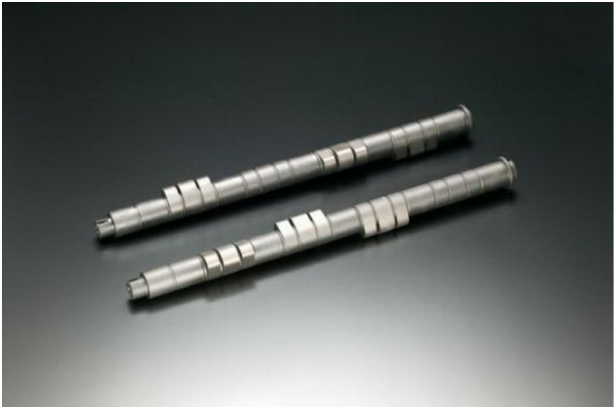
Слика 45. Брегаста вртила која се користе код система са варијабилном шемом развода[6]
