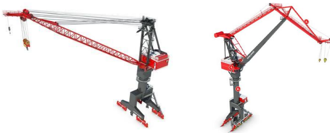
Слика 4. Лучке дизалице са карактеристичном конструкцијом стреле [3]
