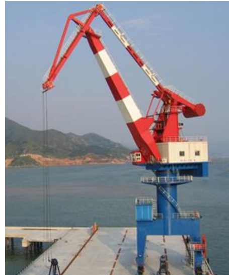
Слика 10. Портална – лучка дизалица са дуплом стрелом [8]
