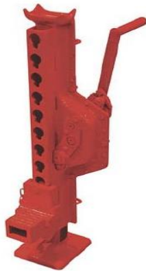
Слика 3.4 Дизалица са зупчастом полугом [5]
