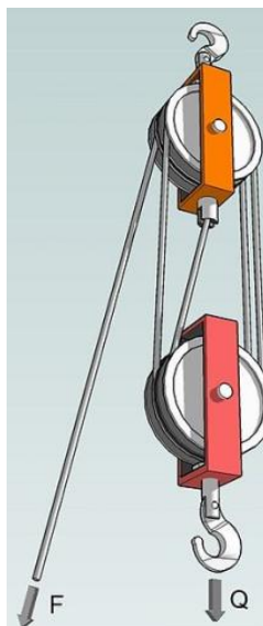
Слика 2.3 Архимедова катурача [4]
