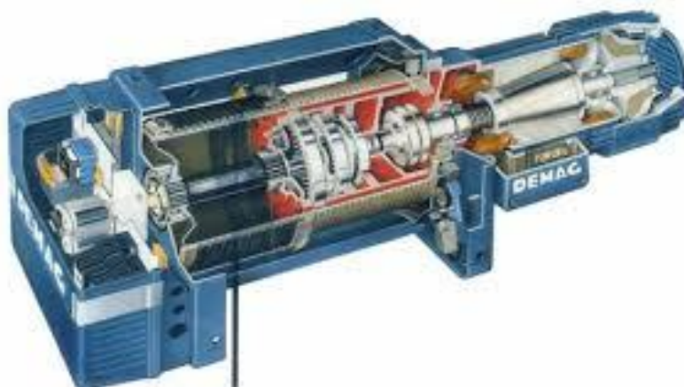
Слика 3.29 Двобрзинско електрично витло типа „Demag” [10]
