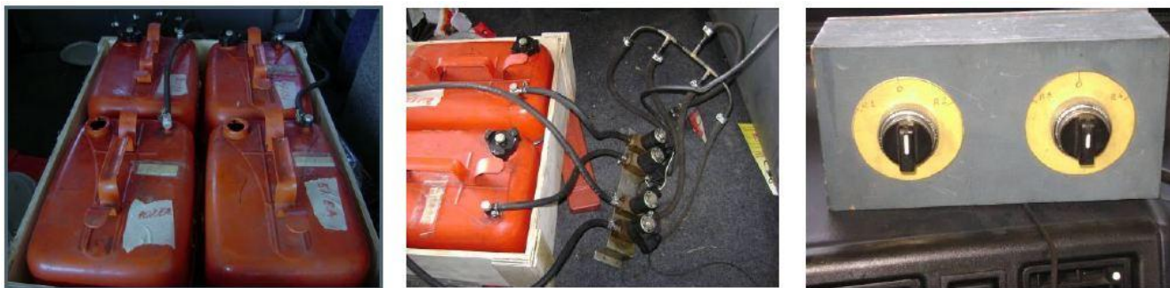
Слика 12- Резервоари за гориво, електроventили и прекидачи за управљање напајним системом горива
