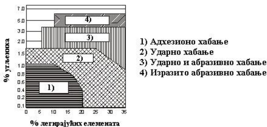
Слика 37 - Избор микроструктура за различите врсте хабања - легуре за наваривање
