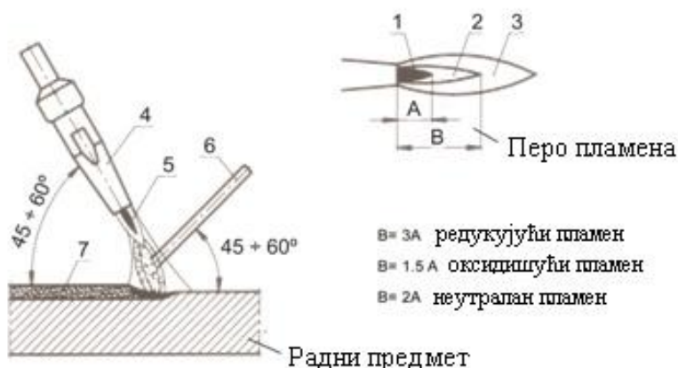
Слика 19 - Шема гасног наваривања и препоручено регулисање окси-ацетиленског пламена
