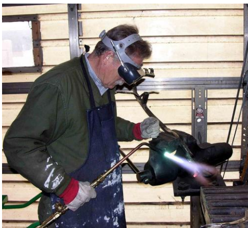
Слика 2 - Гасно заваривање (лево), електролучно заваривање (десно)
