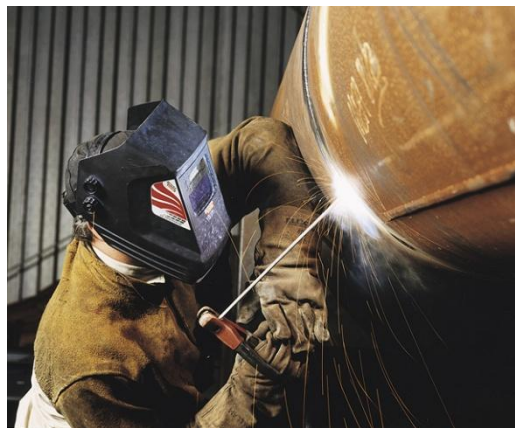
Слика 2 - Гасно заваривање (лево), електролучно заваривање (десно)
