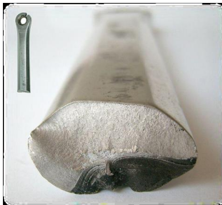
Слика 1 - Лом алуминијумске ручице услед замора материјала [2]
