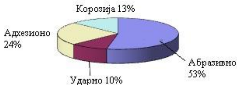
Дијаграм 1 - Избор микроструктура за различите врсте хабања
