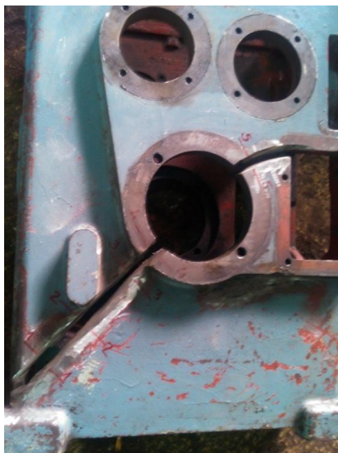
Слика 56 - Изглед оштећења кућишта редуктора од сивог лива
