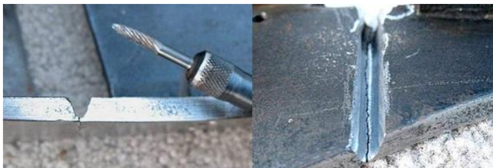
Слика 55 - Примери припреме жлебова за заваривање сивог лива (прилагођавање SL)
