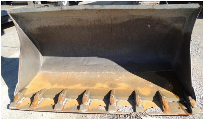
Слика 38 - Зуби багера утоваривача на кашики [7]
