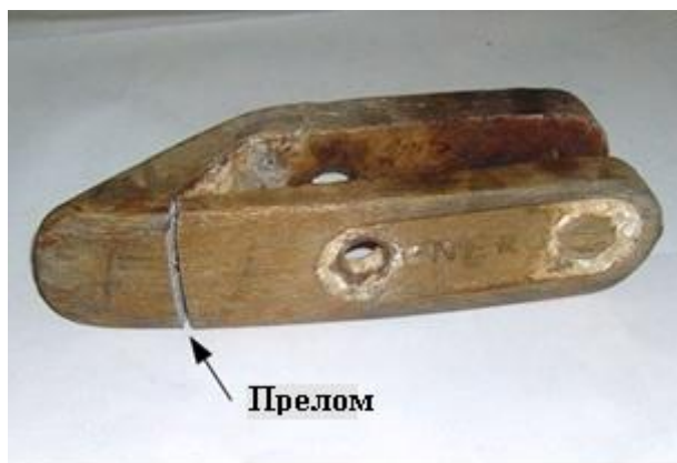
Слика 39 - Изглед зуба утоварне кашике - оштећени производ
