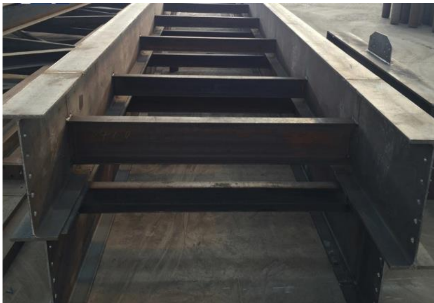
Слика 3.3 Приказ завареног склопа од стандардних I профила
