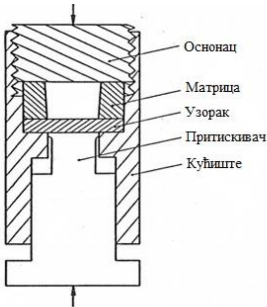
Сл. 1.9. Уређај за хидростатичко испитивање смицањем
