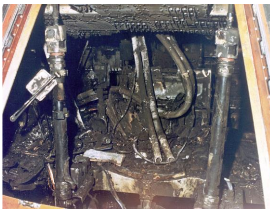
Слика 2.2 Угљенисани остаци кабине Апола 1 [13]
