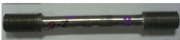
Епрувета за испитивање затезањем - 3C
