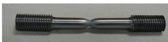
Епрувета после испитивања затезањем - ОМ
