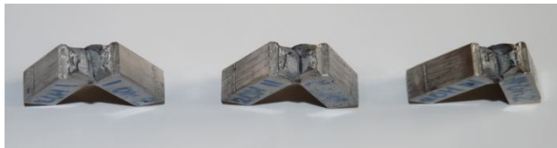
ОМ – плоча 2 – T = -40^{\circ}\text{C}
