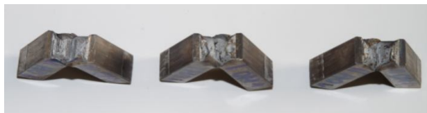
ОМ – плоча 1 – T = -40^{\circ}\text{C}
