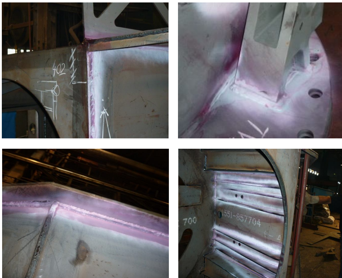
Слика 6.6 Пример пенетрантне контроле на реалним деловима
