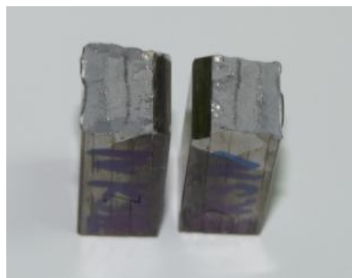
Слика 5.30 Изглед места прелома: корен зона стапања – плоча 2 – узорак 1
