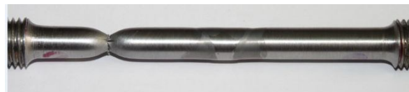
Епрувета после испитивања затезањем - 3C
