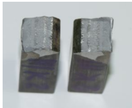
Слика 5.24 Изглед места прелома: корен шави – плоча 2 – узорак 1
