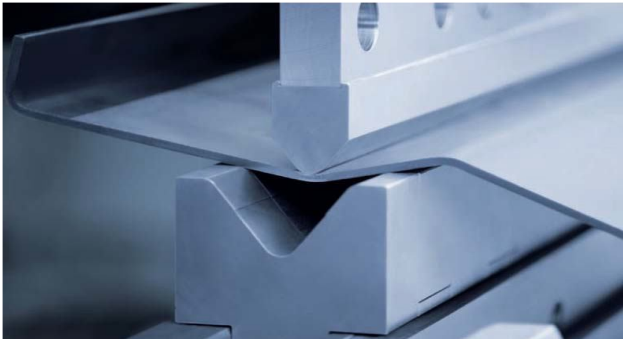
Сл. 3.8 Алат на преси за профилно савијање у захвату (деталј)
