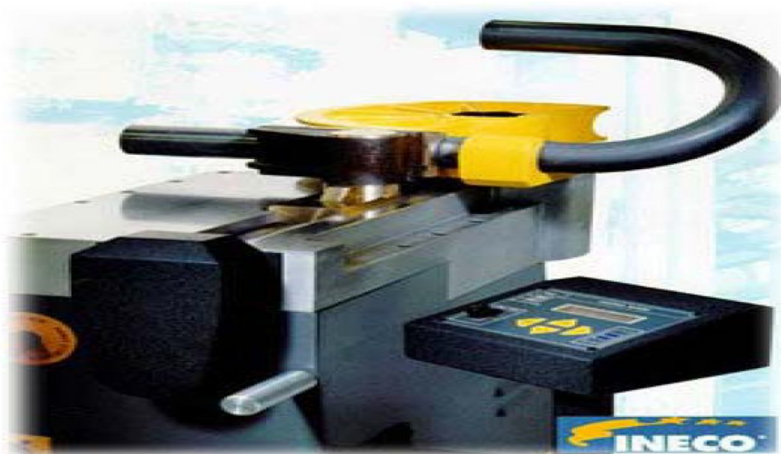
Сл. 3.18 Пример компактне машине за ротационо савијање са управљачком јединицом
