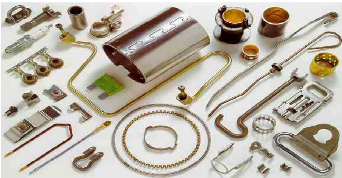
Сл. 3.21 Примери ситних делова добијених обликовањем на аутоматским машинама
