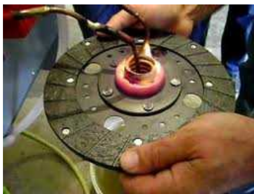
Слика 3.13 Индукционо каљење на ламели
