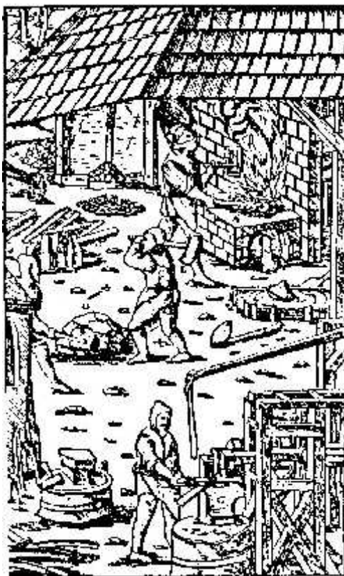
Слика 1.3 Производња челика у плитком огњишту (Немачка - 15. век)
