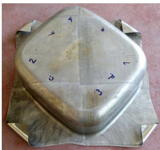
Слика 4.13 Изглед испитиваног отпреска након прве операције
