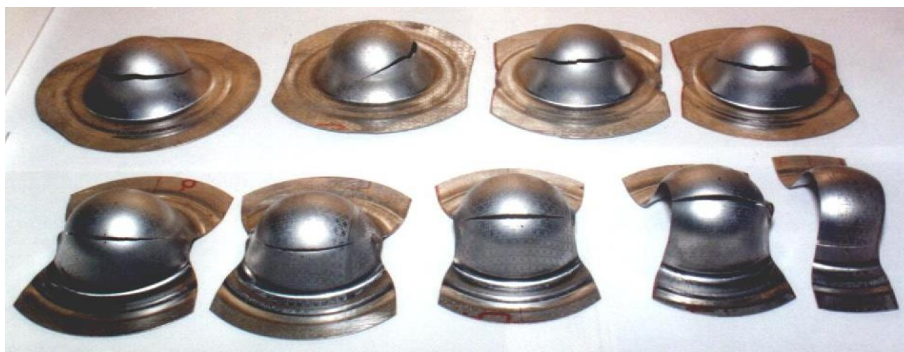
Слика 4.12 Серија епрувета за ДГД од нерђајућег челичног лима Х5CrNi18 9
