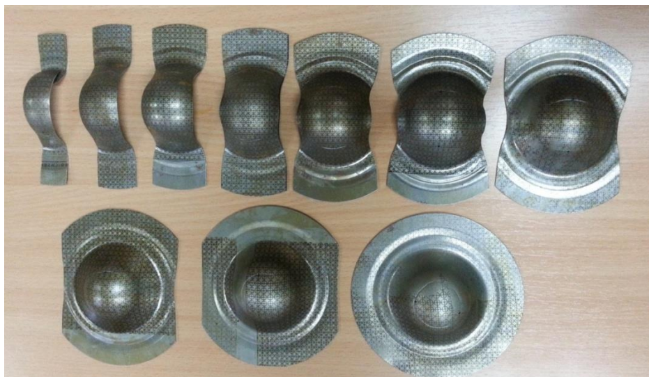
Слика 4.7 Серија епрувета за ДГД лима са превлаком DC04 ZE
