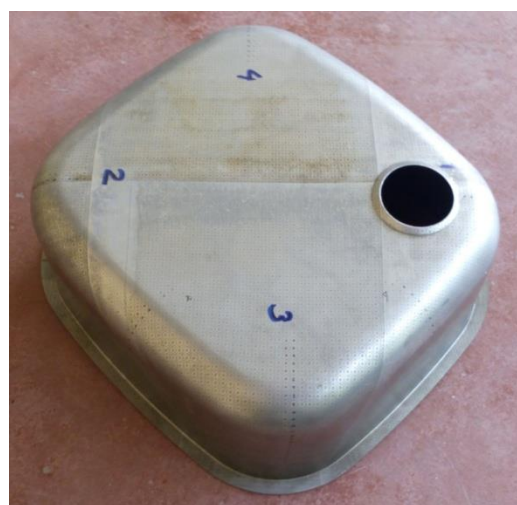
Слика 4.14 Изглед испитиваног отпреска након друге операције
