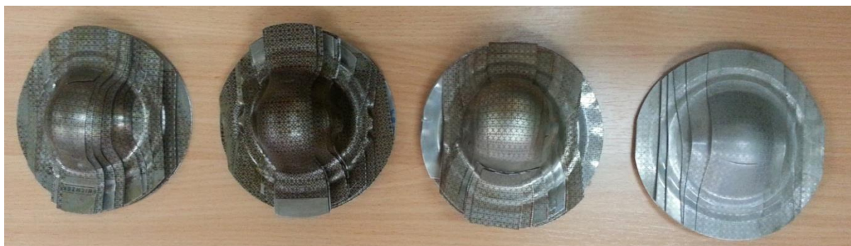
Слика 4.2 Спаковане 4 серије епрувета за одређивање ДГД
