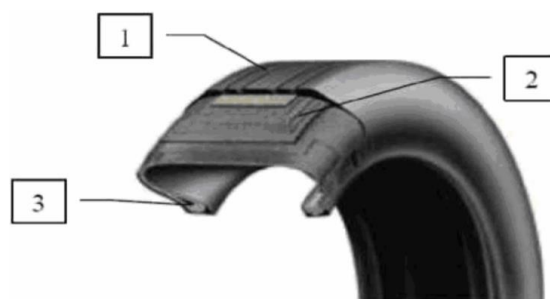
Слика 4.7 Структура ОАП [31] (1 – газећи слој, 2 – тело, 3 –заштита фелне (стопа))
