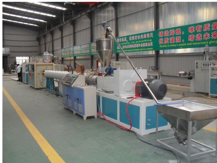
Слика 2.6 Пример континуалног екструдера
