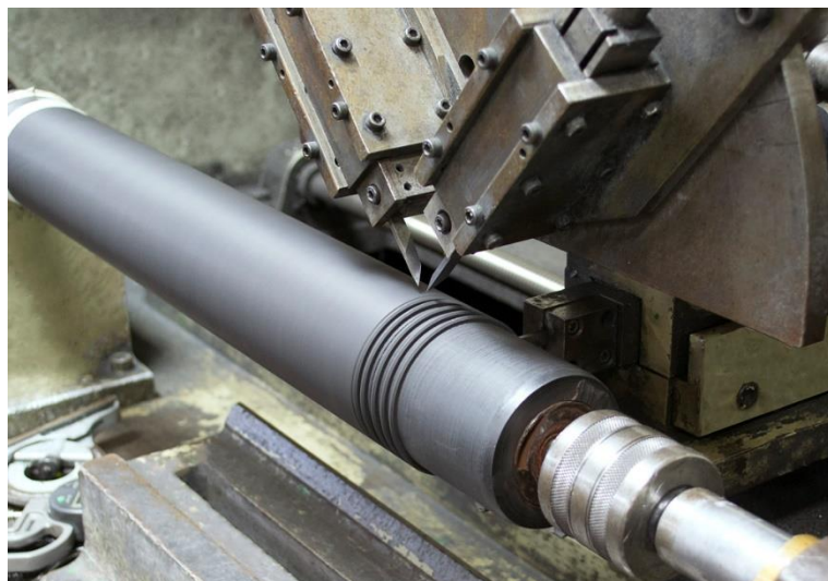
Слика 3.4 Стругање гуменог профила
