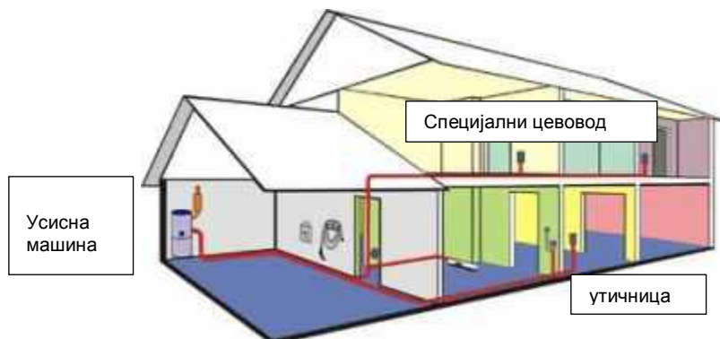
Слика 17. уградња централног система за усисавање
