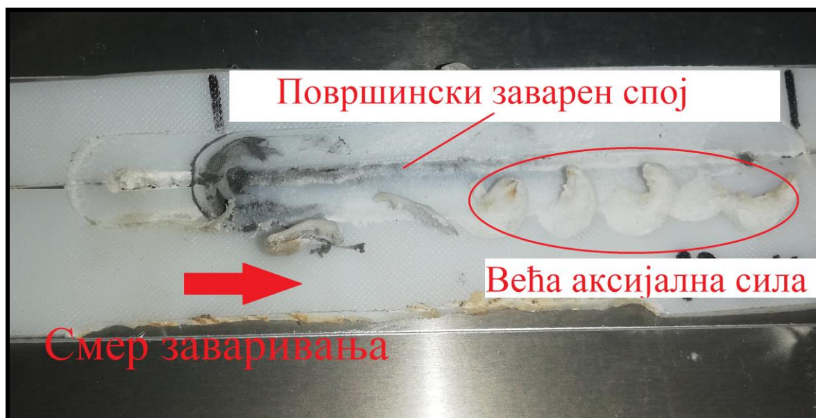
Слика 59. Фотографија резултата изведеног експериментра на глодалици
