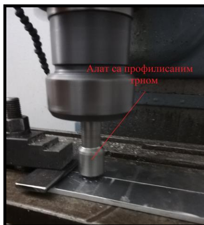
Слика 63. Фотографија експеримента заваривања алуминијума
