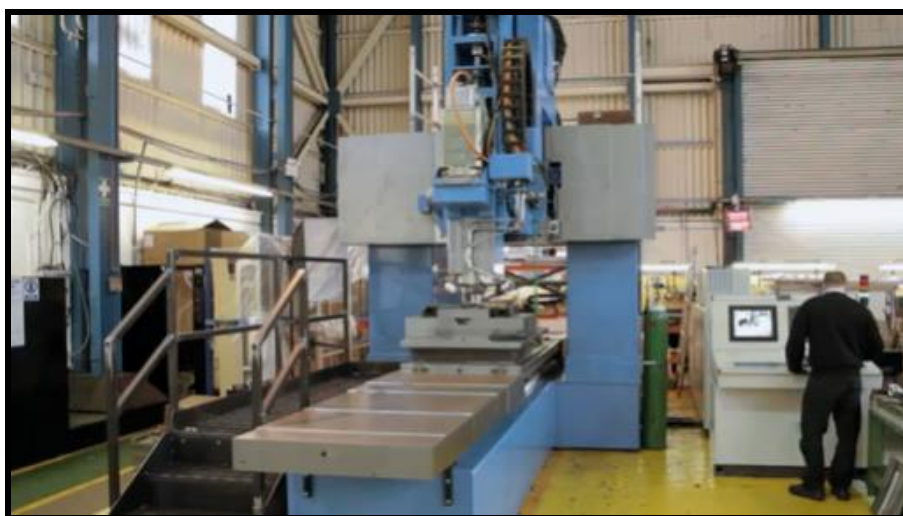
Слика 18. Фотографија FSW машине „PTG-Holroyd precision“ компаније [11]
