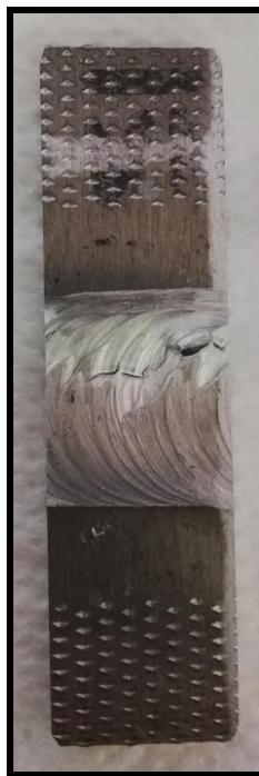
Слика 76. Фотографија епрувете са експериментално најбољим мех. карактеристикама
