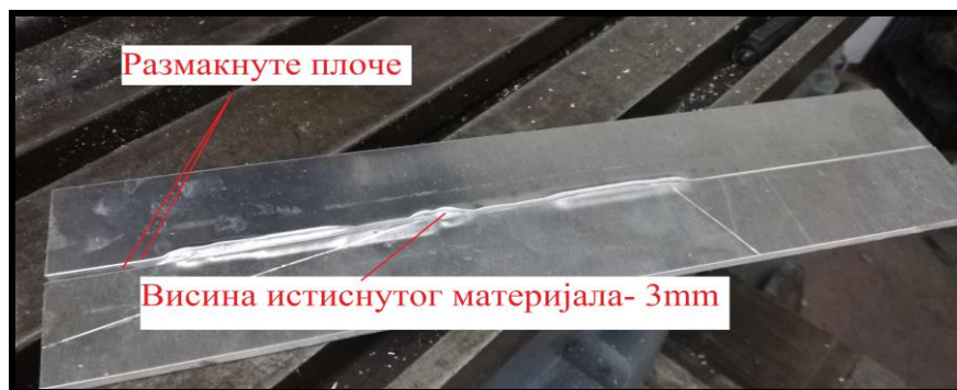
Слика 65. Резултат експерименталног заваривања алуминијума FSW поступком
