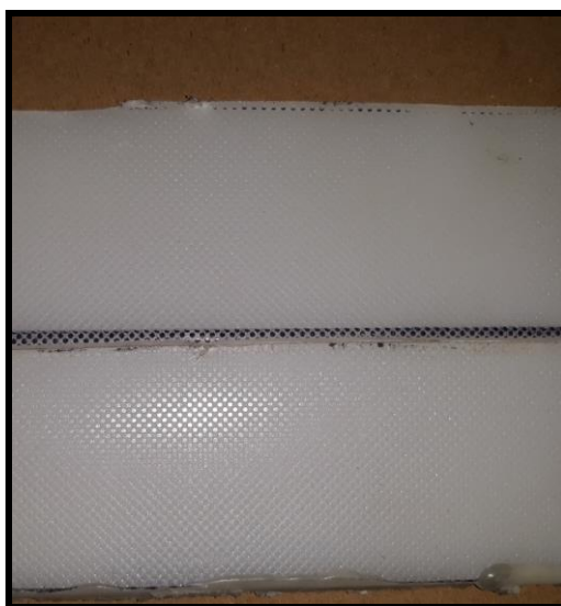
Слика 55. Резултат експеримента са импровизованим алатом-наличије шава
