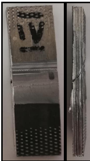
Слика 77. Фотографија епрувете са експериментално најлошијим мех. карактеристикама након лома
