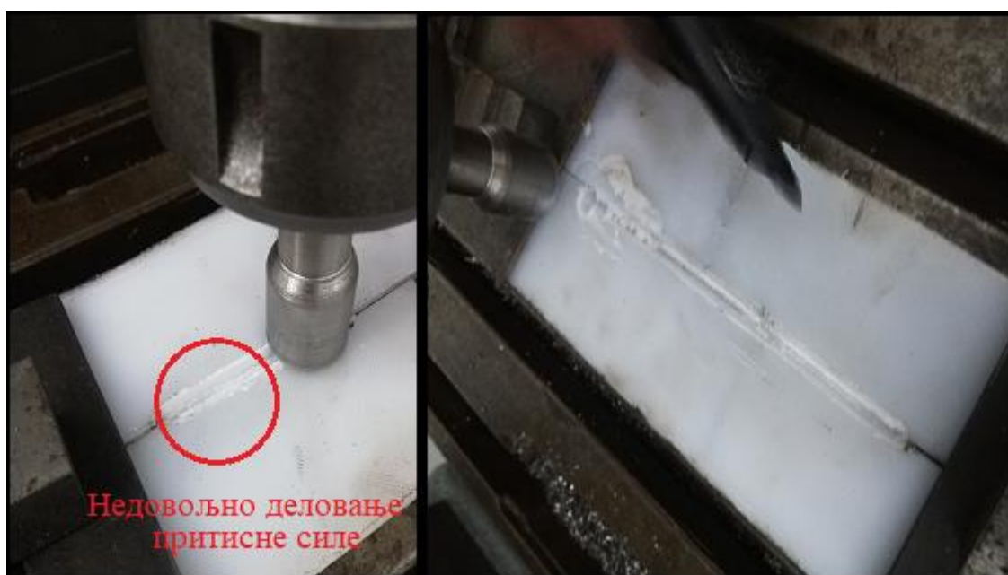
Слика 57. Фотографија резултата изведеног експеримента на глодалици
