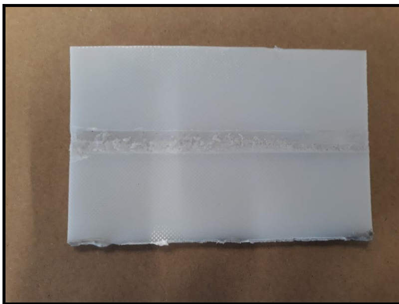
Слика 54. Резултат експеримента са импровизованим алатом-лице шава
