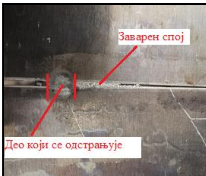
Слика 69. Резултат експерименталног заваривања FSW поступком
