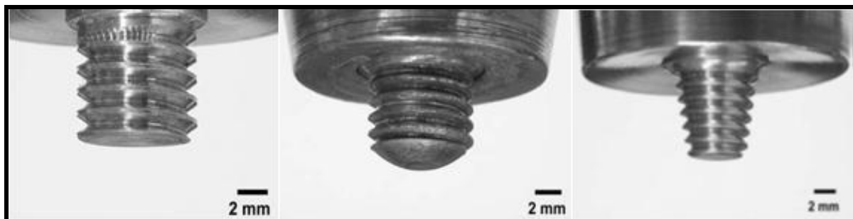
Слика 10. Фотографије: а) цилиндрични трн са равним врхом б) цилиндрични трн са куполом на врху в) трн конусног облика са равним врхом [8]
