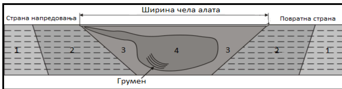
Слика 4. Шематски приказ структуре FSW завареног споја [6]
