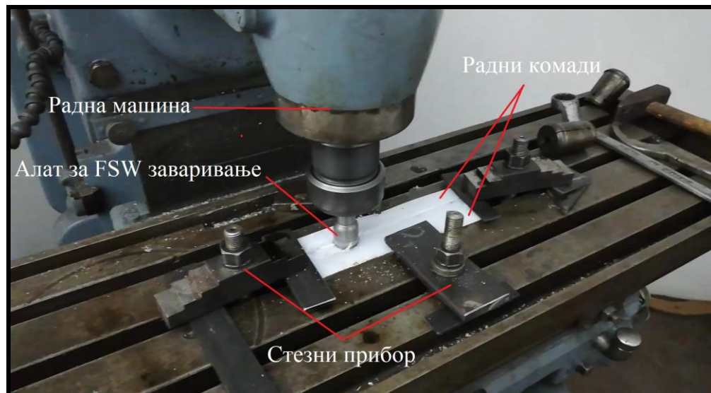
Слика 33. Фотографија начина стезања радног комада при FSW поступку заваривања
