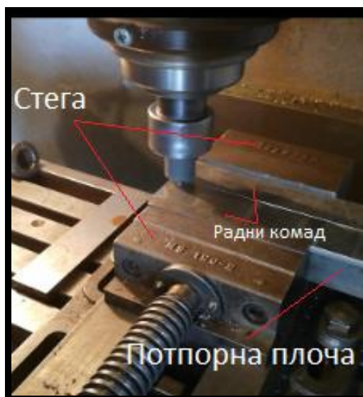
Слика 35. Фотографија начина стезања радног комада при FSW поступку заваривања
