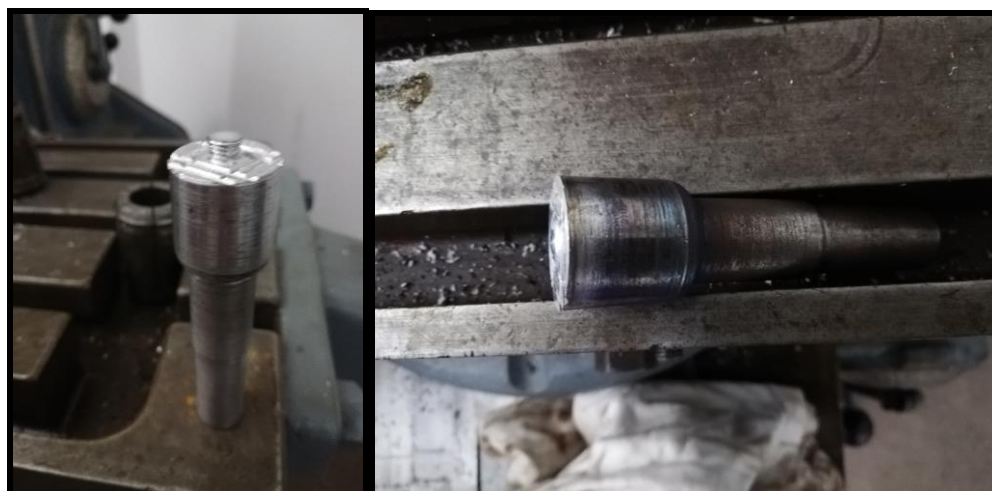
Слика 68. Фотографија алата: а) пре заваривања б) након заваривања
