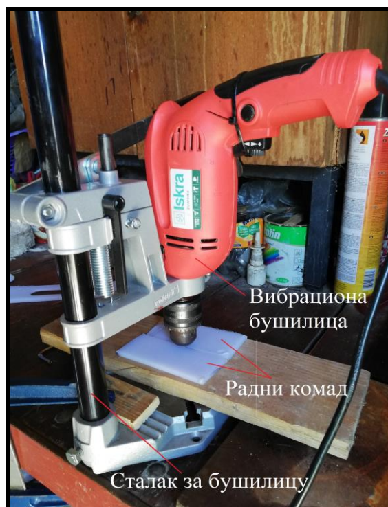
Слика 30. Фотографија експеримента са вибрационом бушилицом
