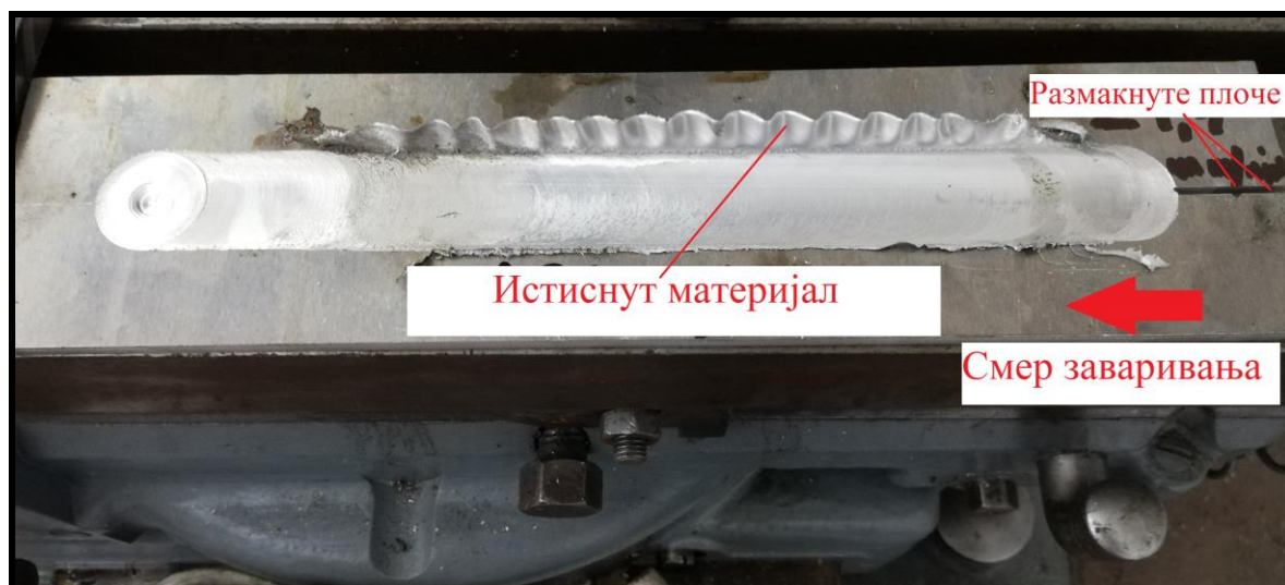
Слика 67. екперименталног заваривања алуминијума FSW поступком
