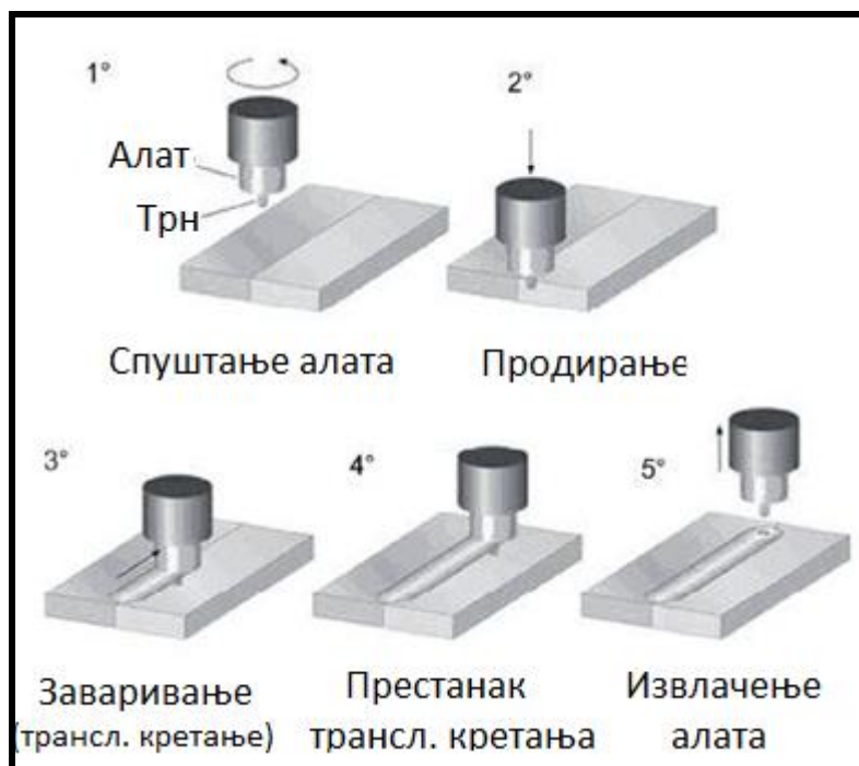
Слика 1. Шематски приказ фаза FSW поступка заваривања [5]
