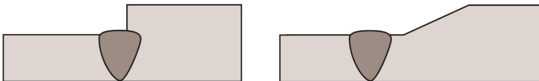
Слика 4.4 – Заварени спој две плоче различитих дебљина (лево) без растерећења и (десно) са глатким прелазом
