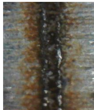
Слика 7.14. Профил гравуре на челику (3 пролаза, снага 100%, брзина 100 mm/s)
