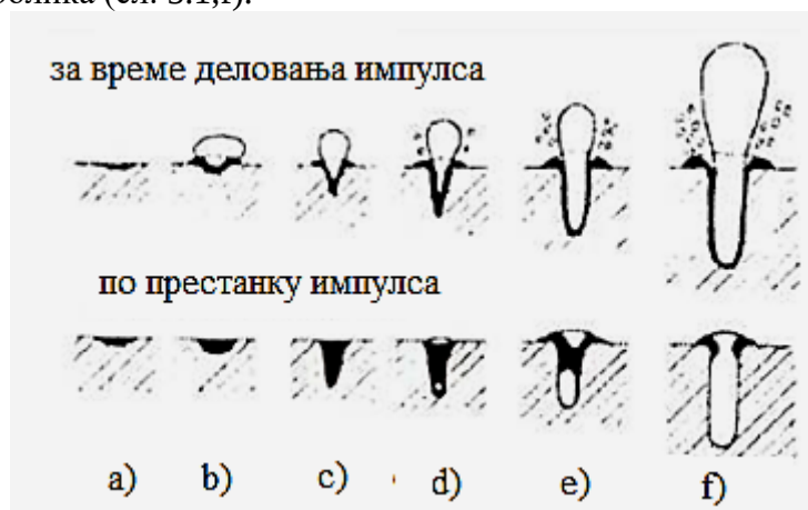
Слика 5.1. Процес стварања рупе у материјалу предмета обраде са променом густине снаге ласерског зрачења [12]
