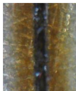
Слика 7.46. Профил гравуре на месингу (2 пролаза, снага 100%, брзина 20 mm/s)
