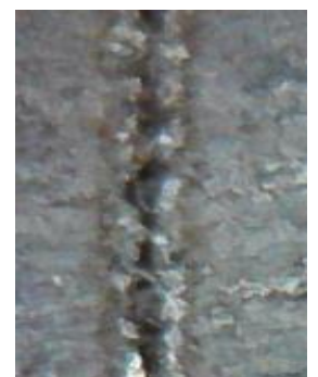
Слика 7.29. Профил гравуре на алуминијуму (3 пролаза, снага 100%, брзина 100 mm/s)
