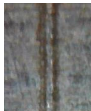
Слика 7.7. Профил гравуре на челику (2 пролаза, снага 55%, брзина 500 mm/s)
