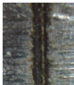
Слика 7.11. Профил гравуре на челику (3 пролаза, снага 80%, брзина 250 mm/s)
