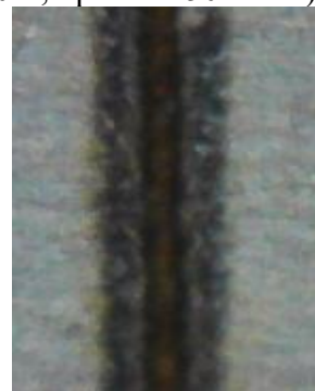
Слика 7.41. Профил гравуре на месингу (3 пролаза, снага 80%, брзина 250 mm/s)
