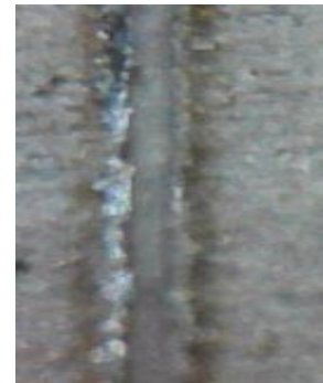
Слика 7.26. Профил гравуре на алуминијуму (3 пролаза, снага 80%, брзина 250 mm/s)
