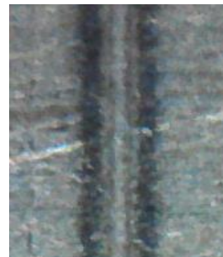
Слика 7.37. Профил гравуре на месингу (2 пролаза, снага 55%, брзина 500 mm/s)
