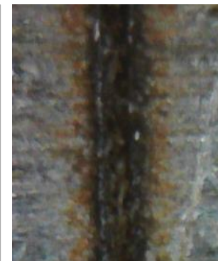
Слика 7.13. Профил гравуре на челику (2 пролаза, снага 100%, брзина 100 mm/s)
