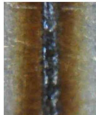
Слика 7.47. Профил гравуре на месингу (3 пролаза, снага 100%, брзина 20 mm/s)
