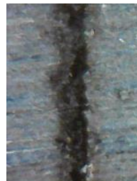
Слика 7.32. Профил гравуре на алуминијуму (3 пролаза, снага 100%, брзина 20 mm/s)
