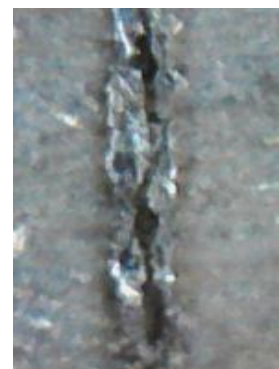
Слика 7.31. Профил гравуре на алуминијуму (2 пролаза, снага 100%, брзина 20 mm/s)
