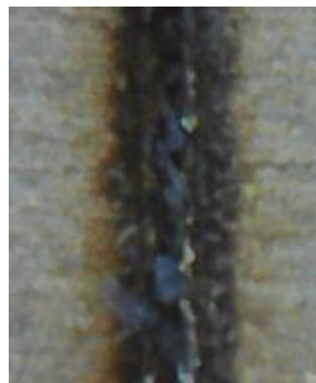
Слика 7.44. Профил гравуре на месингу (3 пролаза, снага 100%, брзина 100 mm/s)
