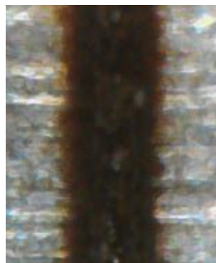
Слика 7.15. Профил гравуре на челику (1 пролаз, снага 20%, брзина 100 mm/s)
