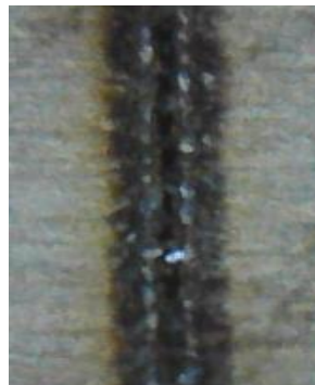
Слика 7.43. Профил гравуре на месингу (2 пролаза, снага 100%, брзина 100 mm/s)
