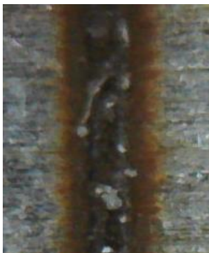
Слика 7.17. Профил гравуре на челику (3 пролаза, снага 20%, брзина 100 mm/s)
