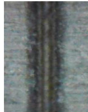
Слика 7.40. Профил гравуре на месингу (2 пролаза, снага 80%, брзина 250 mm/s)
