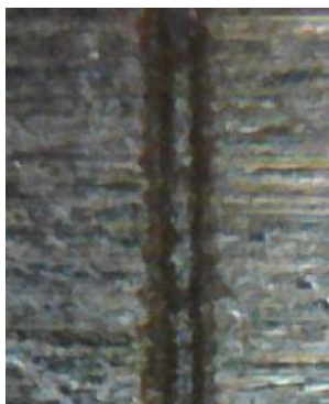
Слика 7.9. Профил гравуре на челику (1 пролаз, снага 80%, брзина 250 mm/s)
