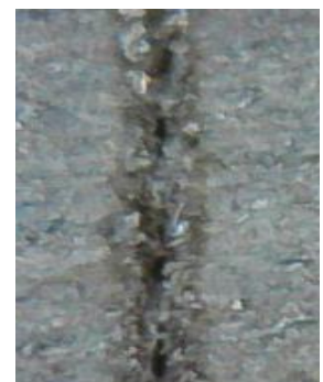
Слика 7.28. Профил гравуре на алуминијуму (2 пролаза, снага 100%, брзина 100 mm/s)
