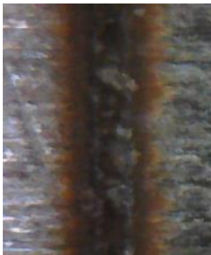
Слика 7.16. Профил гравуре на челику (2 пролаза, снага 20%, брзина 100 mm/s)
