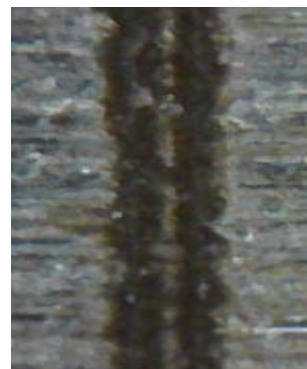
Слика 7.10. Профил гравуре на челику (2 пролаза, снага 80%, брзина 250 mm/s)
