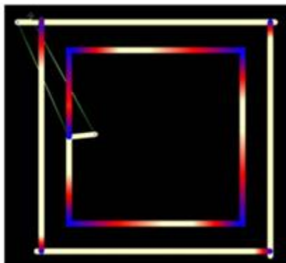
Слика 4.27. Са додатком компезације динамичког пробијања и угаоног пролаза, време обраде је 13,7 min [10]
