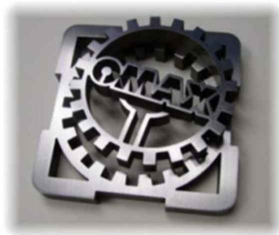
Слика 4.29. Комад са уским толеранцијама, израђен од челика дебљине 1cm [10]
