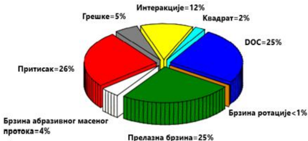
Слика 4.14. Процентуални допринос појединих утицаја на геометријску грешку [9]
