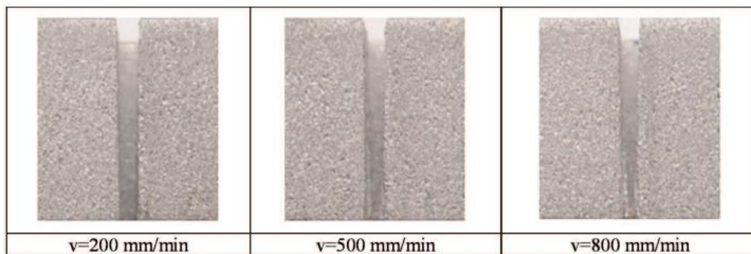
Слика 4.36. Фотографије облика реза при различитим брзинама сечења [17]
