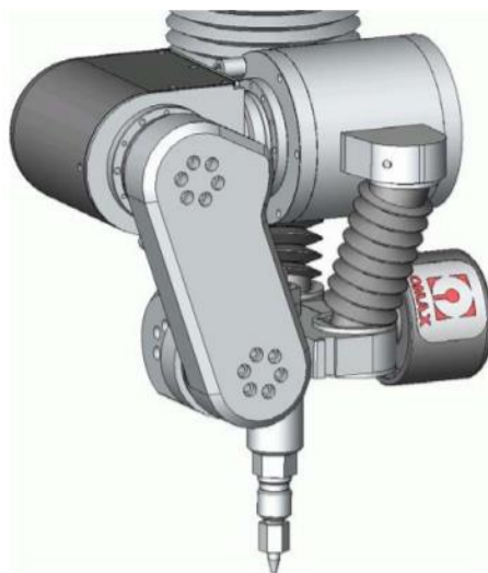
Слика 4.33. Солид модел коначног дизајна механизма за нагињање млазнице [10]
