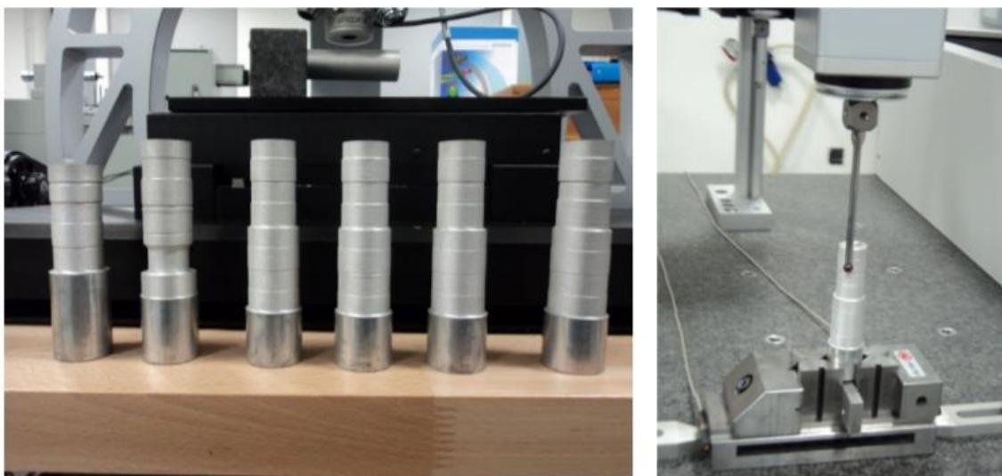
Слика 4.24. (а) Делови обрађени абразивним воденим млазом; (б) Мерење пречника комада после извршене обраде, на уређају Zeiss Prismo 5 HTG VAST CMM [9]
