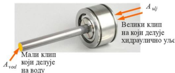
Слика 3.3. Однос површина одређује степен појачавања притиска [2]
