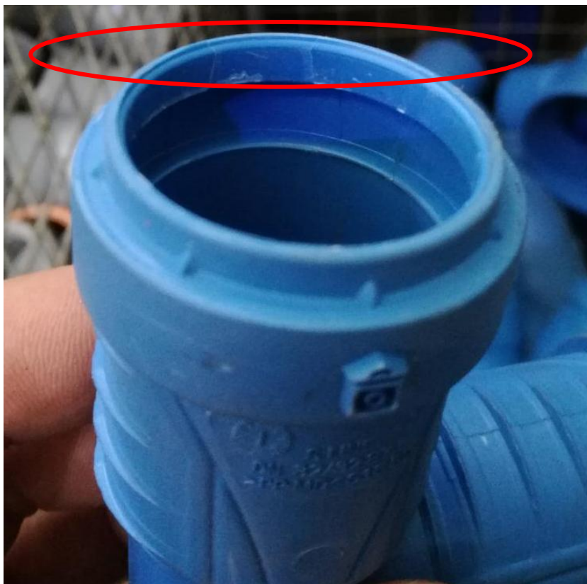
Слика 8.5. Дефект производа настао због лоше обрађеног прстена
