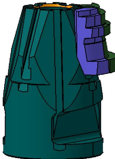
Слика 7.8. Носач сегмената (са два сегмента)
