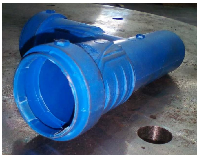
Слика 8.6. Дефект производа настао због лоше обраде и сегмената и прстена
