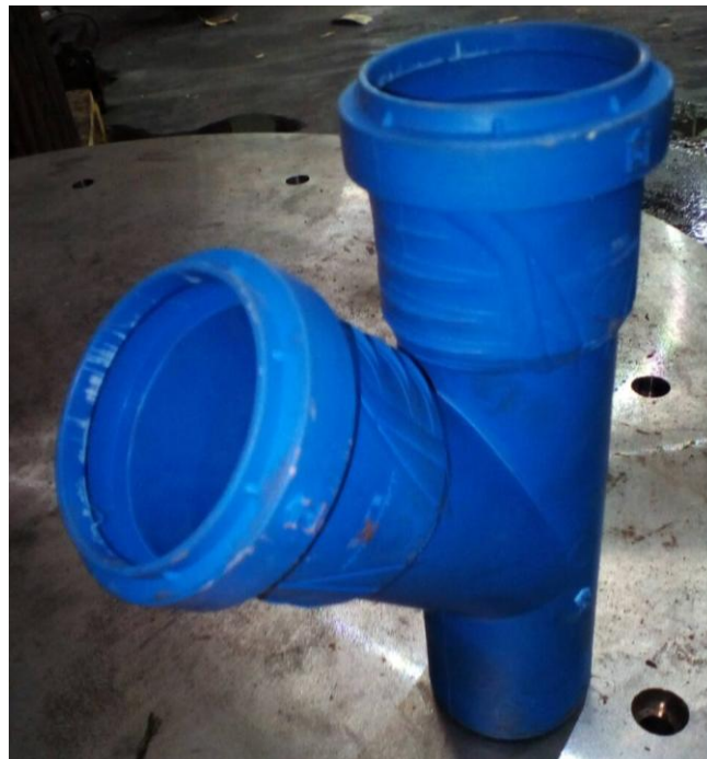
Слика 8.4. Дефект производа настао због лоше обрађених сегмента
