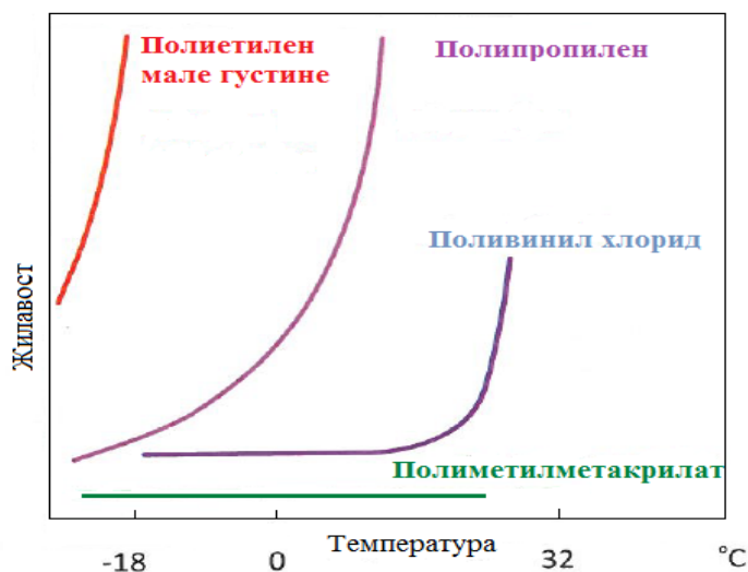
Слика 3.9 Утицај температуре на жилавост за различите полимере [2]
