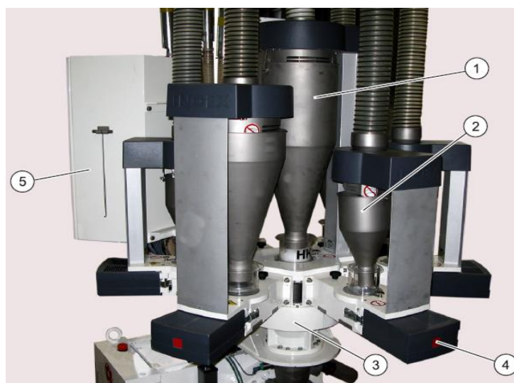
Слика 6.11 Систем дозирања 1- главне компоненте левка за дозирање, 2- споредне компоненте левка за дозирање, 3- комора за мешање, 4- пужни систем дозирања, 5- разводни орман. [11]
