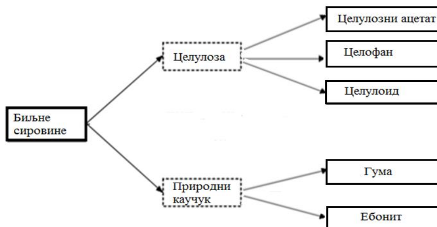
Слика 4.4 Шема финалних производа добијених на бази биљних сировина [3]
