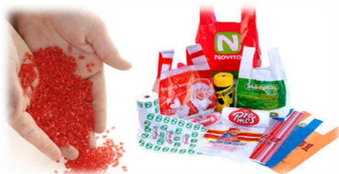
Слика 1.2 Полимерни материјал у облику гранула и производ добијен прерадом полимера [1]
