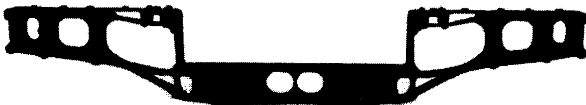
Слика 20 Сегмент каросеријског прстена нископодног приградског аутобуса MAN NU 263/313 [17]
