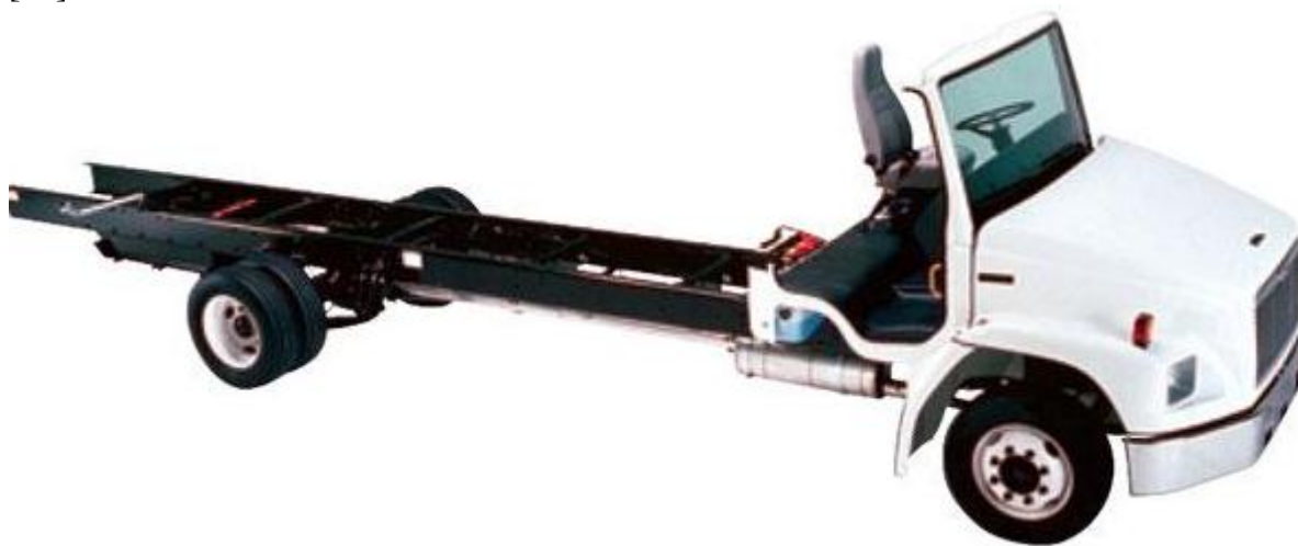
Слика 15 Камионска шасија која се примењивала у почетку производње аутобуса[19]
