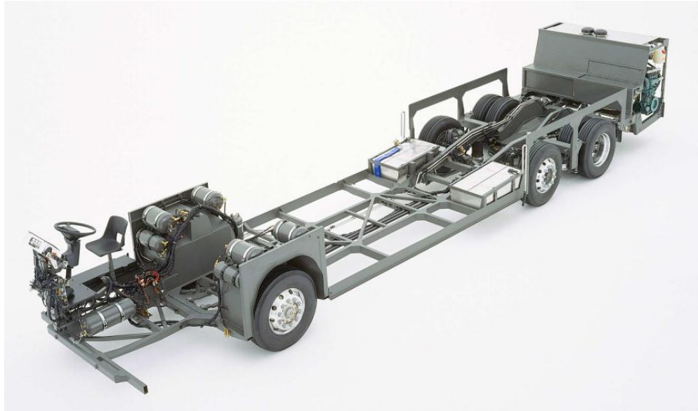
Слика 24 Лонжеронска рамна шасија за аутобус са мотором позади [8]
