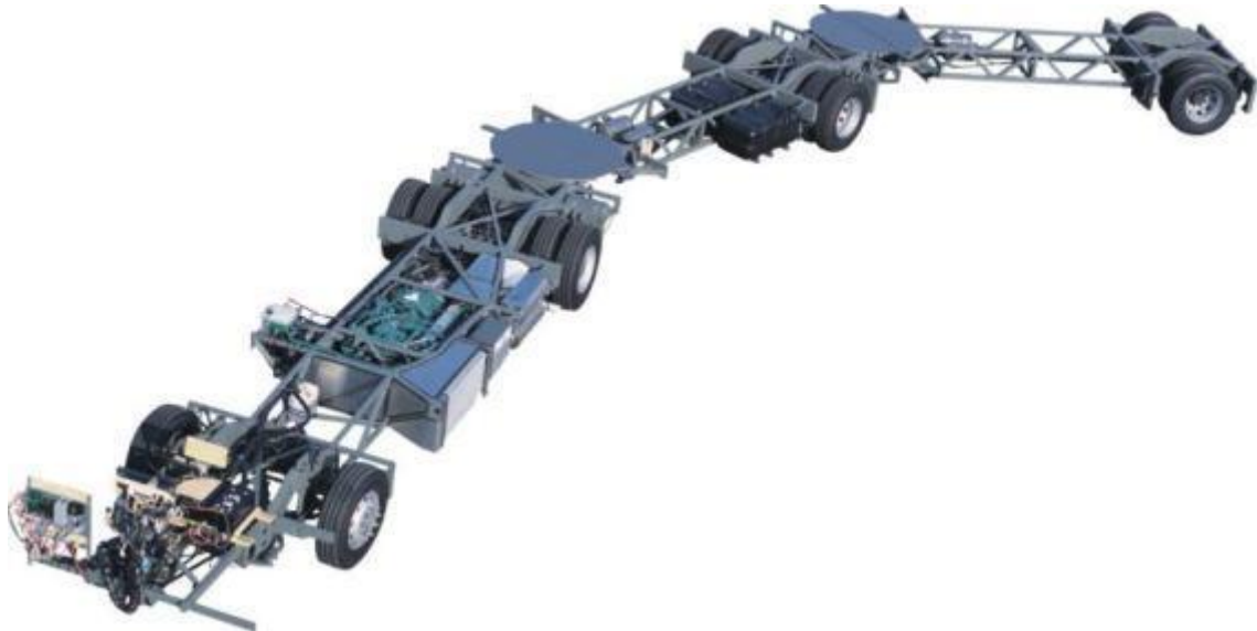
Слика 33 Шасија зглобног аутобуса са две „приколице“ [19]
