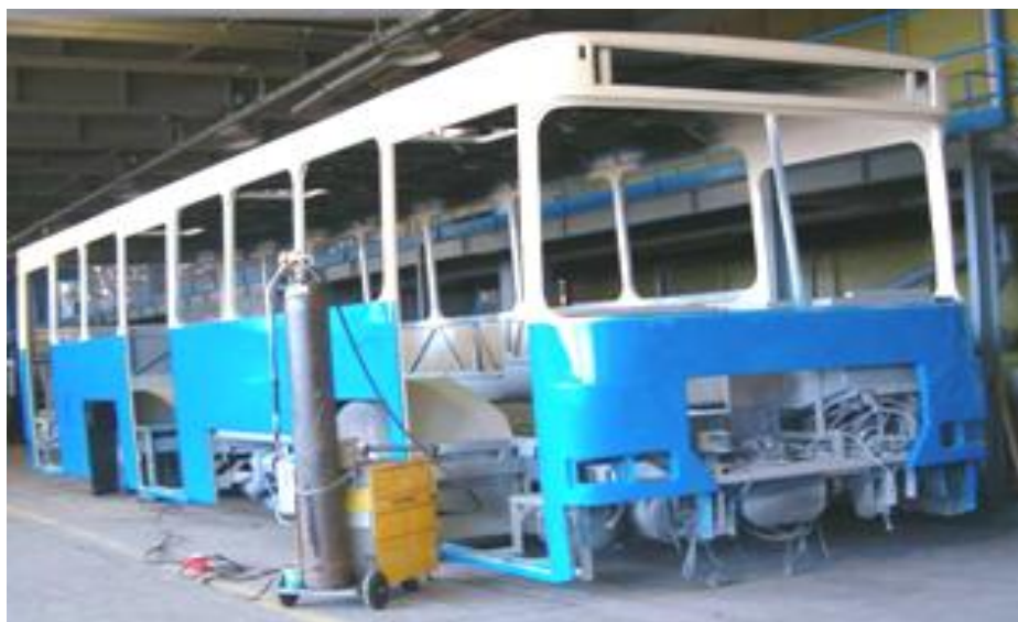
Слика 29 Линија за завршну монтажу Low Entry модели NB 501 G на шасији Volvo двоја и троја врата B7R LE с. [10]
