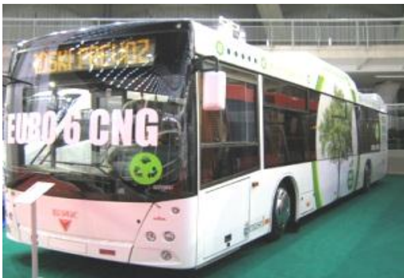
Слика 7 „MAZ-BIK 203 CNG“ – Градски нископодни аутобус на природни гас [20]
