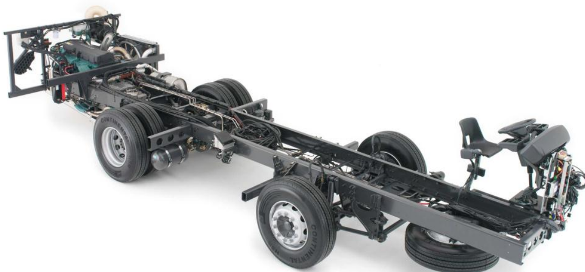
Слика 23 Лонжеронска рамна шасија на бази камиона [8]
