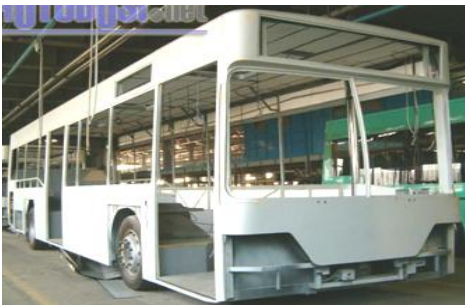
Слика 28 Костур нископодног аутобуса NB 503 G-Neobus [10]
