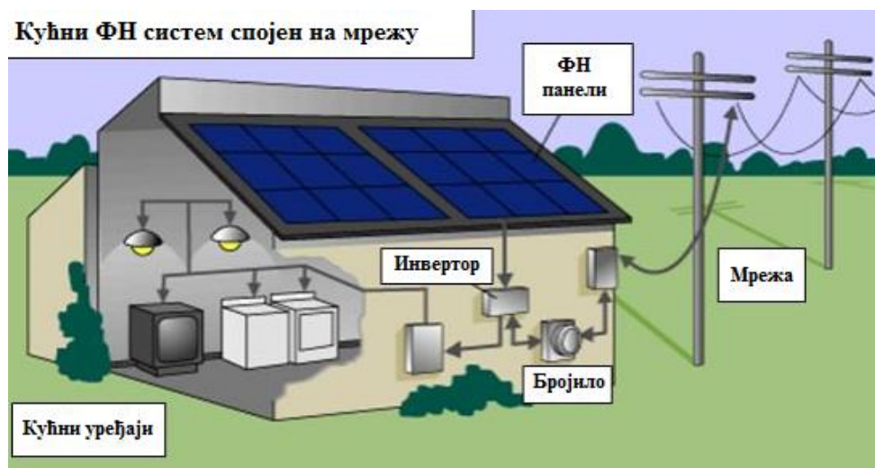
Слика 5. Мрежно повезани фотонапонски систем [15]
