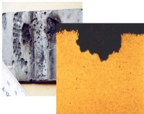
Слика 9. Разарања материјала пегастом корозијом[9]
