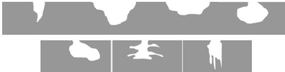
Слика 10. Облик рупица код рупичасте корозије [12]
