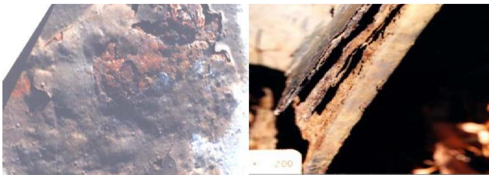
Слика 11. Бубрење и листање материјала код потповршинске корозије [13]
