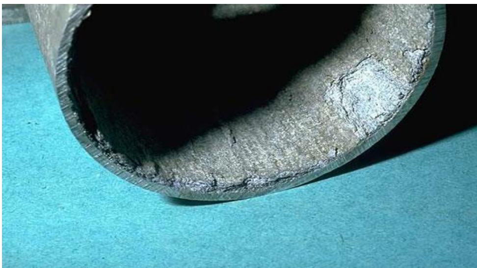
Слика 13. Селективна корозија [14]
