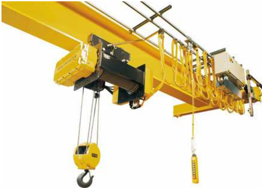
Слика 39. Реални приказ мостне дизалице коришћене у производним условима за транспорт делова
