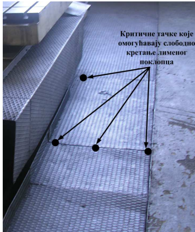
Слика 41. Приказ неправилно постављеног лименог поклопца на резервоару машине
