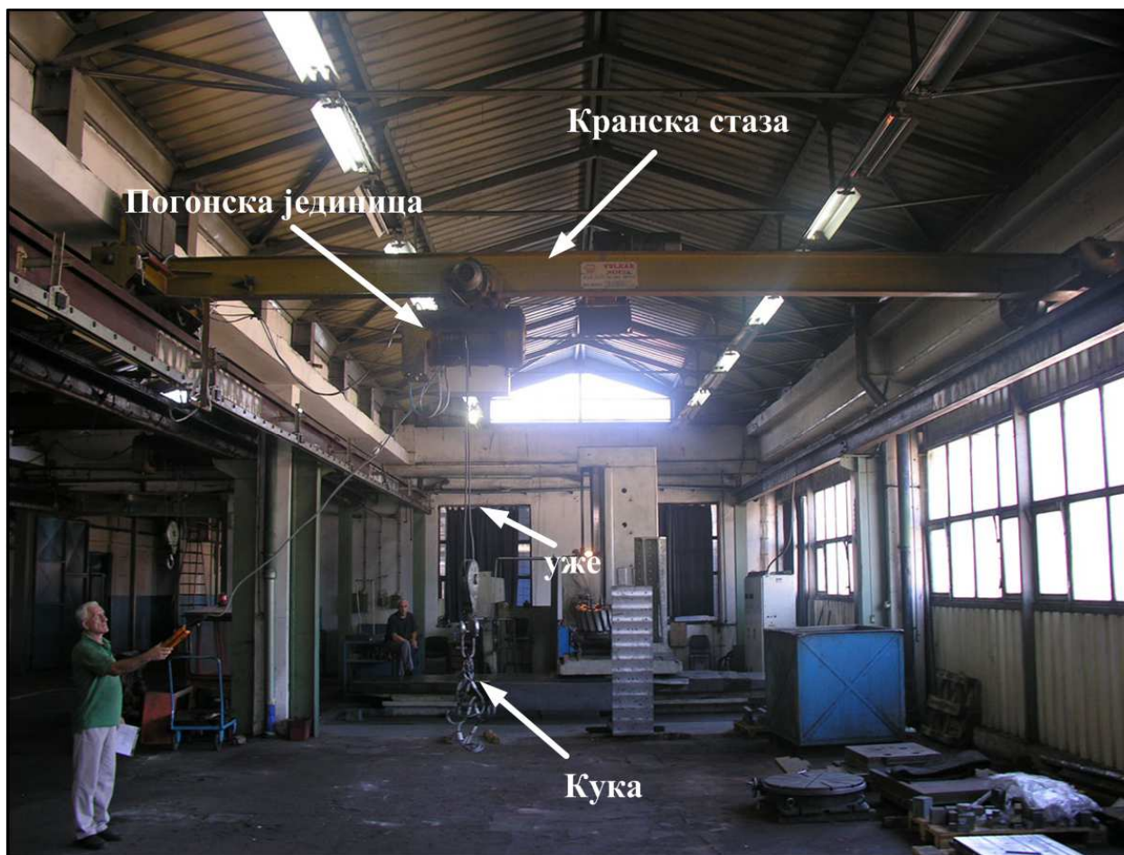
Слика 48. Приказ мосте дизалице са неким од елемената означених на слици који могу да угрозе безбедност радника
