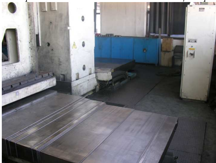
Слика 42. Приказ добро постављених лимених поклопаца на резервоару машине
