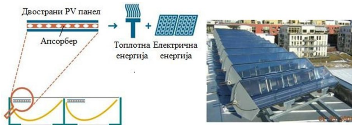
Слика 4.3.2.2. Шема и изглед концентришућег PV/T соларног пријемника са непокретним панелима [7]
