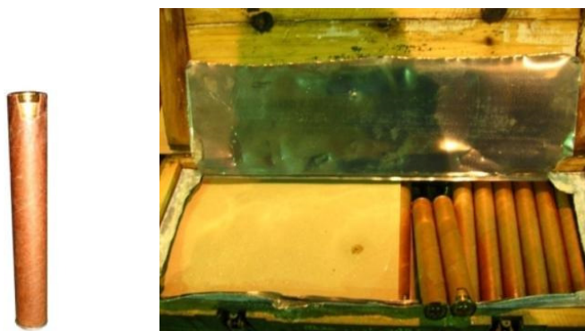
Слика 7. Изглед муниције 20×110 mm у микроамбалажи (лево) и у макроамбалажи (десно) [3]
