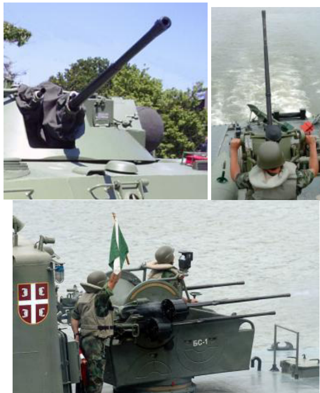
Слика 1. Артиљеријска оруђа калибра 20×110 mm у наоружању ВС [1]: аутоматски (противавионски) топ 20 mm М55 на БВП М80А (горе лево), бродски топ 20/1 mm М71 (горе десно) и бродски топ 20/4 mm М75 (доле).
