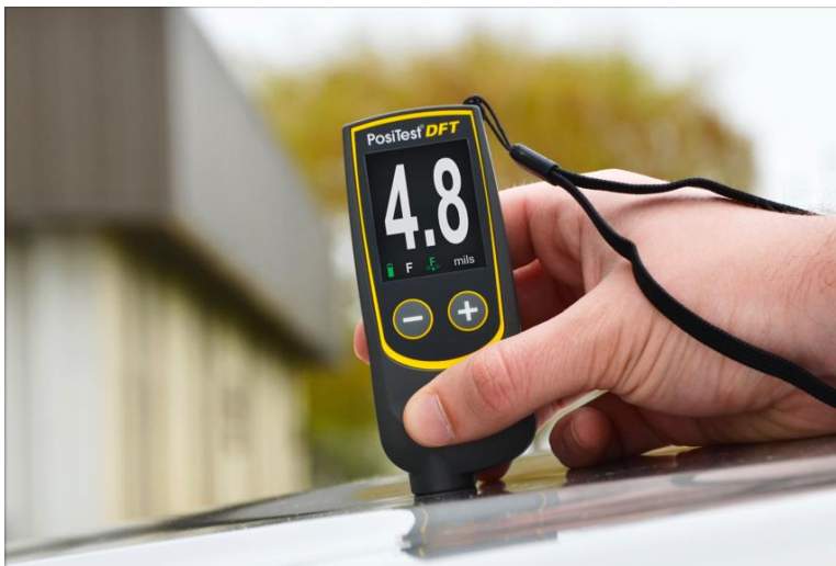
Слика 4: Магнетни уређај за мерење дебљине сувог слоја са константним притиском
