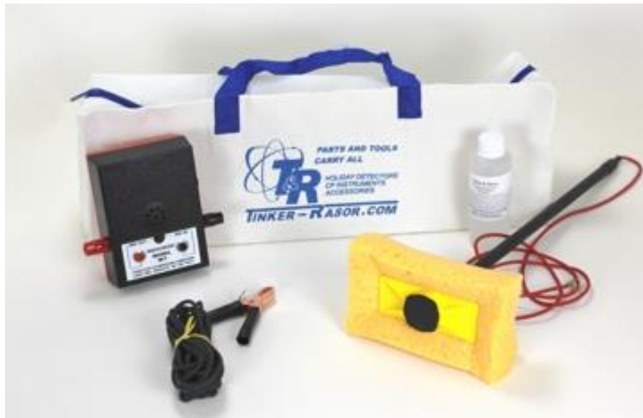
Слика 11: Нисконапонски детектор оштећења – влажни сунђер
