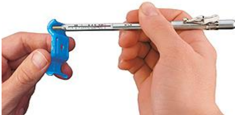
Слика 3:Магнетни уређај за мерење дебљине сувог слоја са повлачењем, модел оловке
