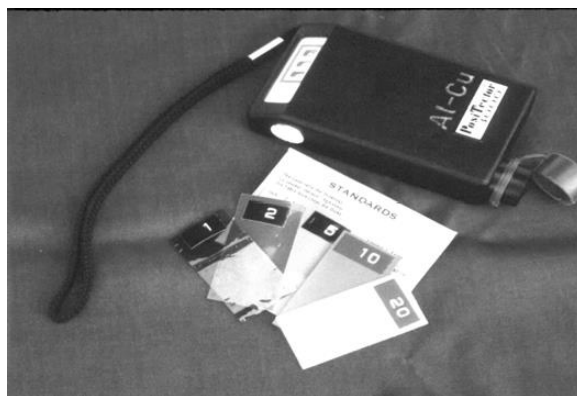
Слика 7: Калибрација уређаја за мерење са сондом под константним притиском са пластичним плочицама
