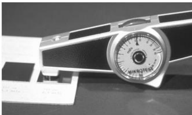
Слика 6: Калибрација магнетног уређаја за мерење дебљине сувог слоја са повлачењем на подложним плочицама Националног института стандарда и технологија (NIST)
