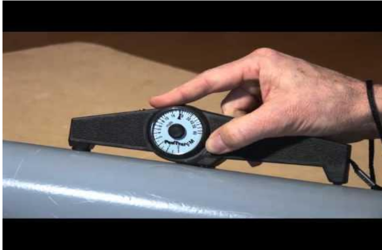
Слика 2:Магнетни уређај за мерење дебљине сувог слоја са повлачењем и бројчаником
