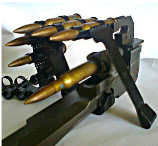
Слика 4.1. Положај покретних делова митраљеза у тренутку опаљења
