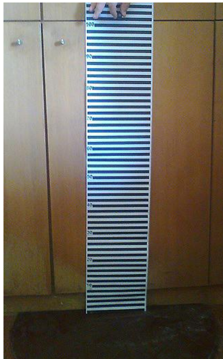
Слика 4.18. Скала за мерење висине одскока, челична куглица и плоча од текстолита
