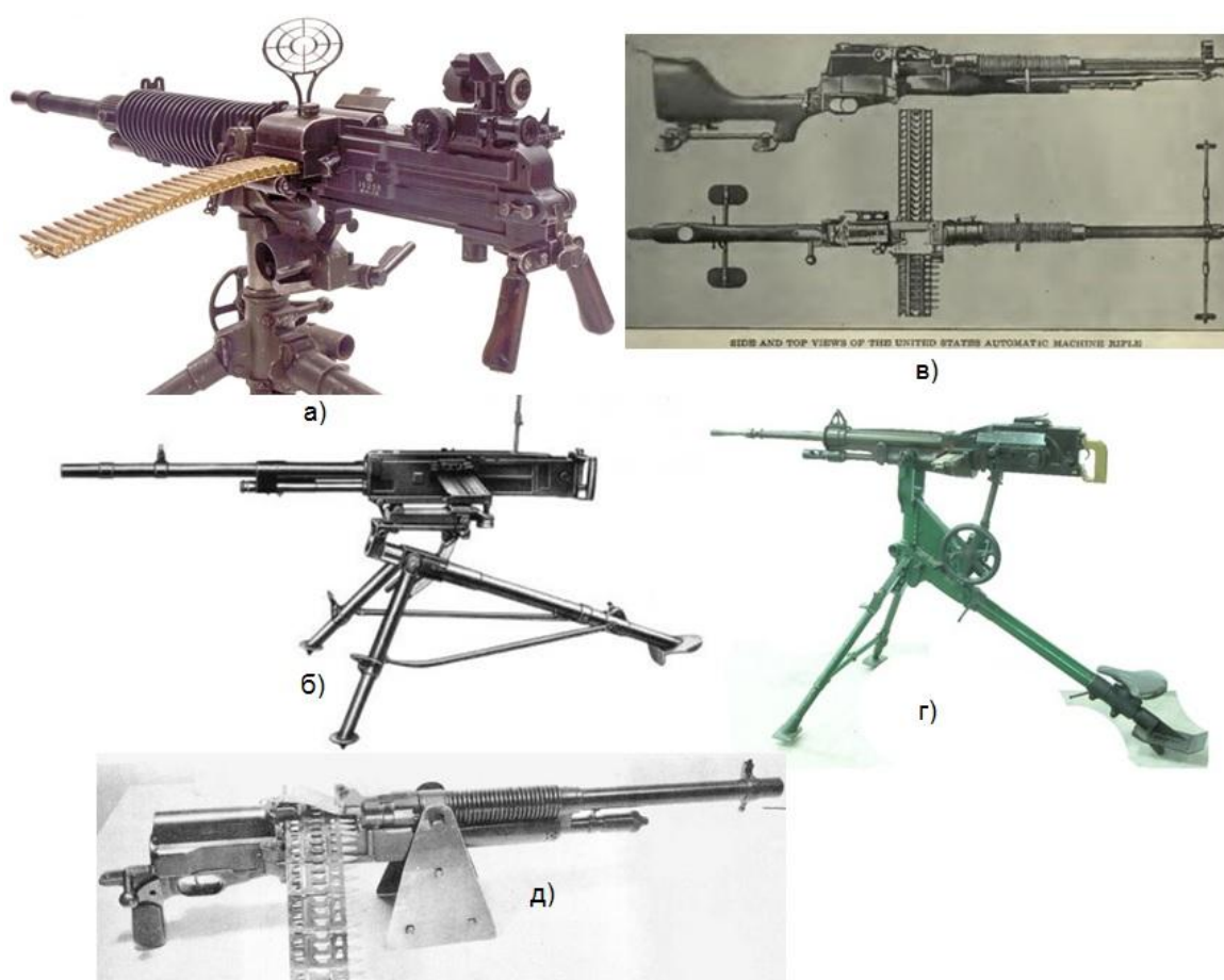
Слика 2.11. Митраљези који се хране помоћу трака и касета: а) јапански Type 92, б) италијански Breda M1937, в) амерички Benet-Mercie M1909, г) Etienne Model 1907, д) Hotchkiss Portable machine gun Mark I
