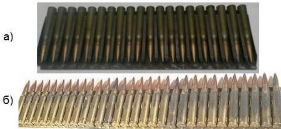
Слика 2.10. Касета уз помоћ које се храни митраљез: а) италијански Breda M1937, б) јапански Type 92
