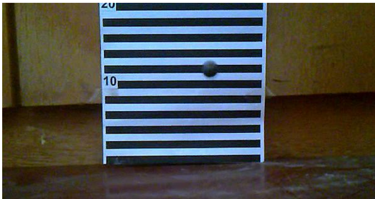
Слика 4.19. Одређивање висине одскока челичне куглице
