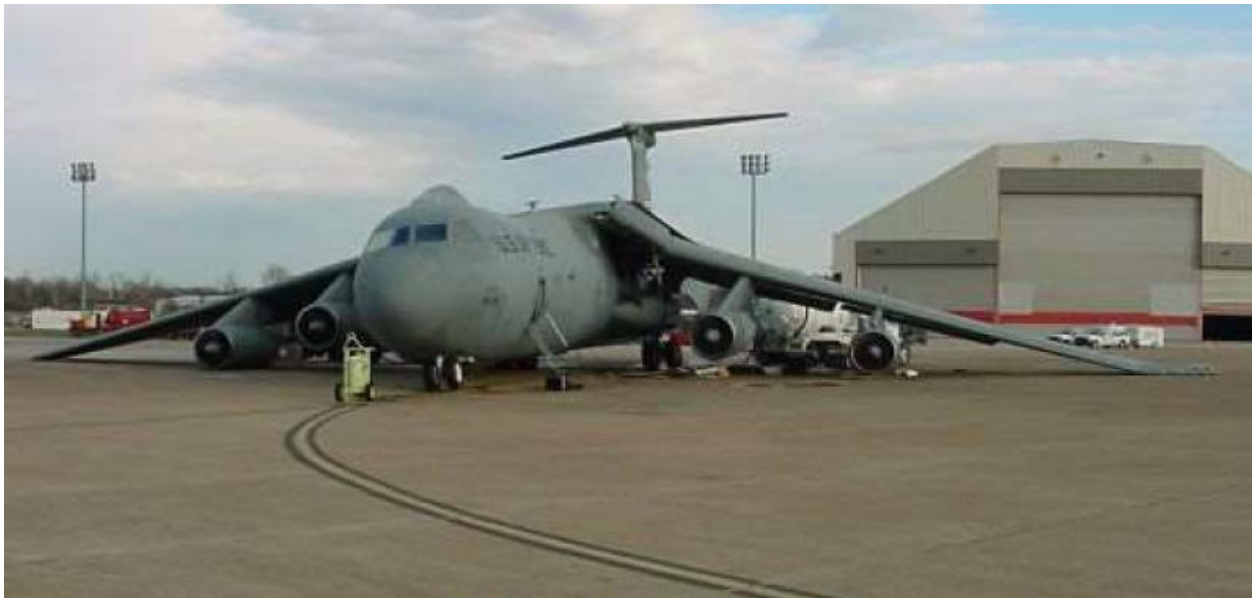
Слика 11 : Крило авиона C-141 StarLifter који припада USAF (америчком ратном ваздухопловству), срушило се током допуњавања горива за пут у Немачку. [11]
