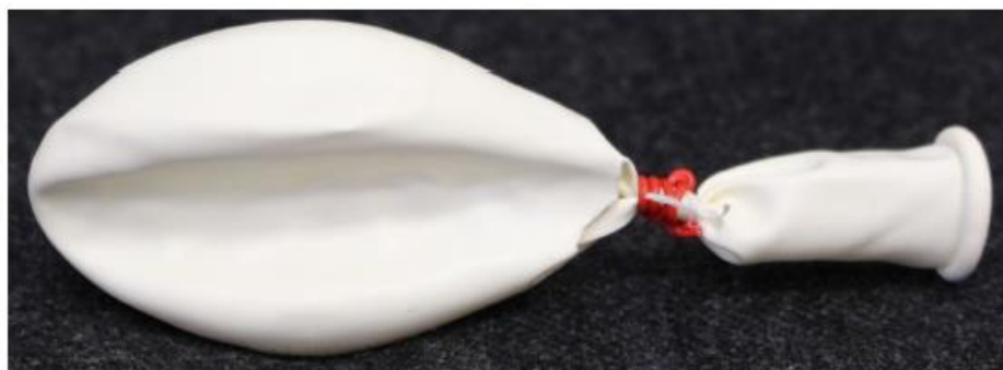
Слика 5.13: Восак запечаћен у балону од латекса након поновног учвршћивања и отклањања ваздуха вакуумом. [20]
