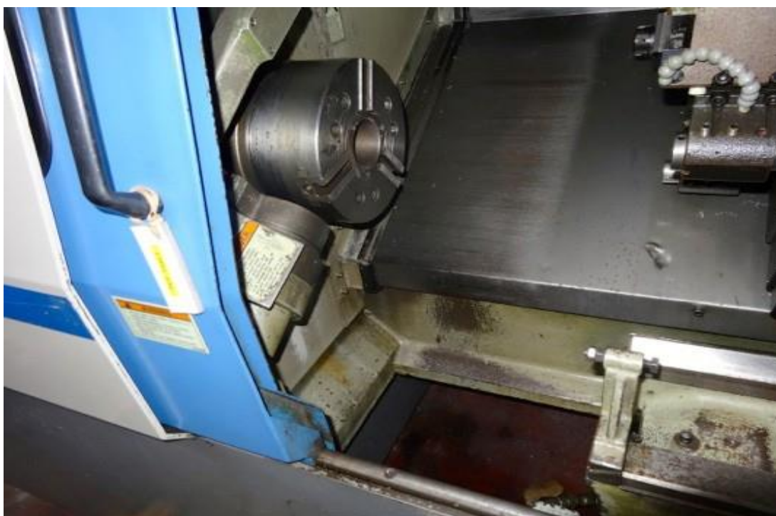
Слика 3.2 Стезна глава машине Hyundai HIT20M
