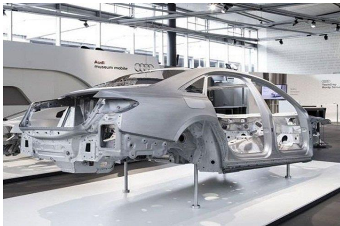
Слика 9. Алуминијумска шасија Аудијевог аутомобила
