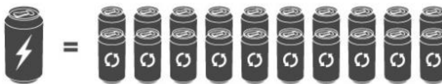
Слика 41. Разлика утрошка енергије за производњу од сировог и рециклираног алуминијума
