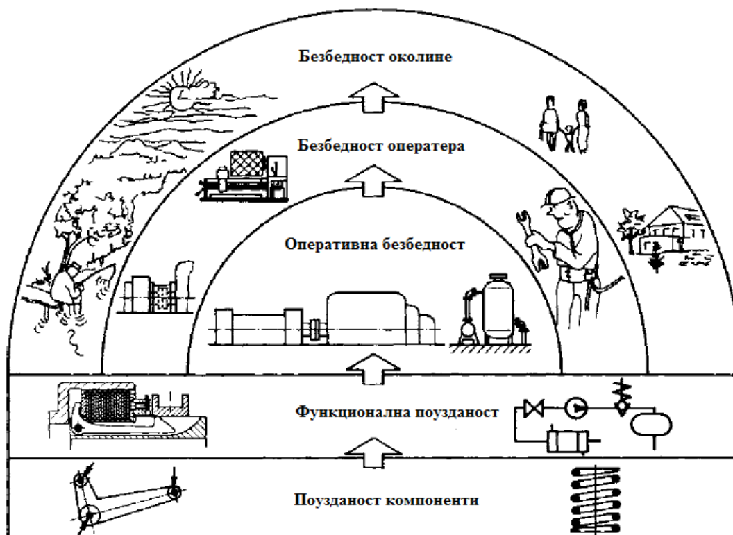
Слика 5. Веза између поузданости компоненти и функционалне поузданости, с једне стране и оперативне безбедности, безбедности оператора и животне средине са друге[2]
